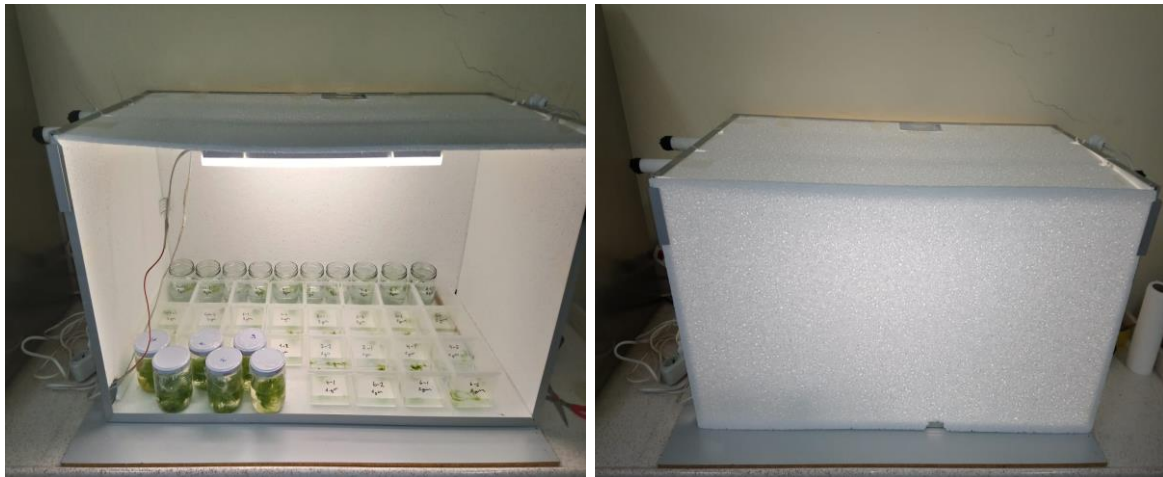
Şekil 3.2. 1,3 ve 5 gün boyunca numunelerin bekletildiği ortam düzeneği
