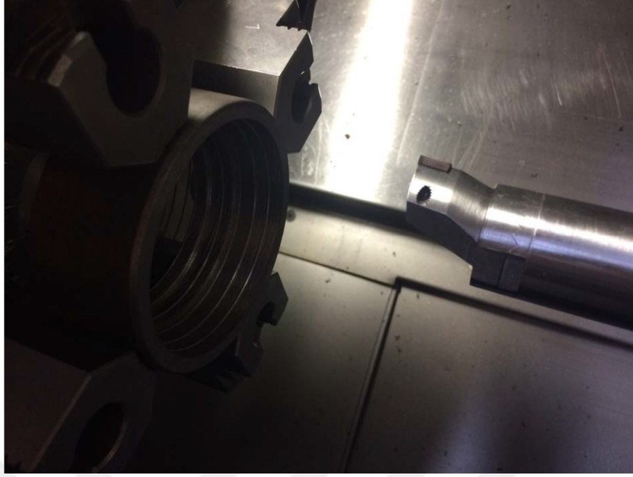
Şekil 3.15. Kater Kesme Kafası, Kesici uç ve İş parçası
