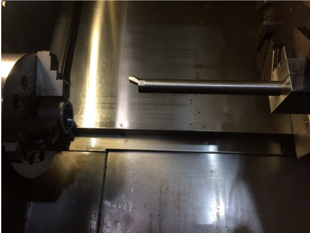
Şekil 3. 5. S32 448 Anti Vibrasyon Delik İçi İşleme Kateri ve CCMT09T308 Kesici Uç
