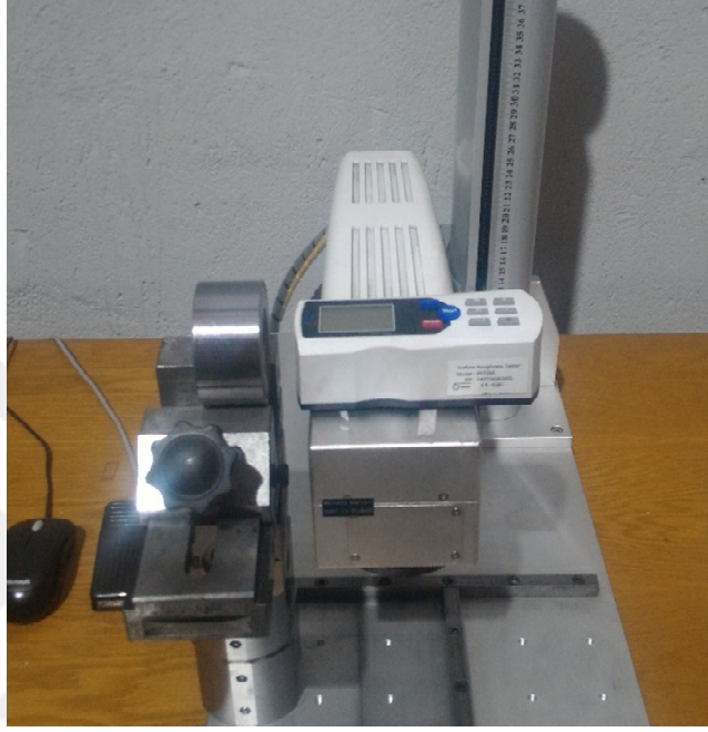
Şekil 3. 1. Yamer PST200 marka yüzey pürüzlülük ölçüm cihazı (Yamer Endüstri)
