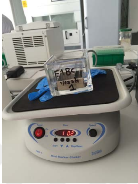
Şekil 3.34. Slide rackların Wash Buffer solüsyonu ile karıştırılması
