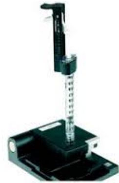
Şekil 3.14. Jel-boya karışımının eklenerek RNA çip istasyonunun kapatılması
