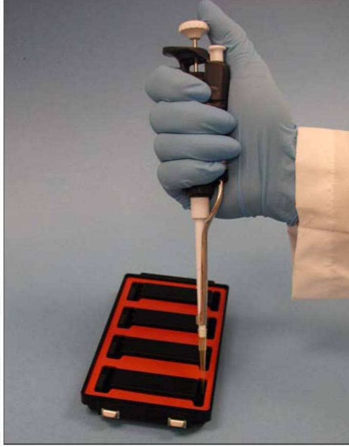
Şekil 3.25. Hibridizasyon Çember Haznesine HCB eklenmesi
