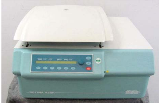
Şekil 3.41. Slide rack santrifüj aşaması
