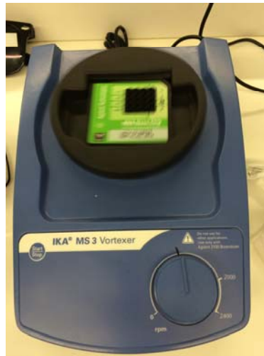
Şekil 3.17. RNA çipi için özel olarak tasarlanmış vorteks
