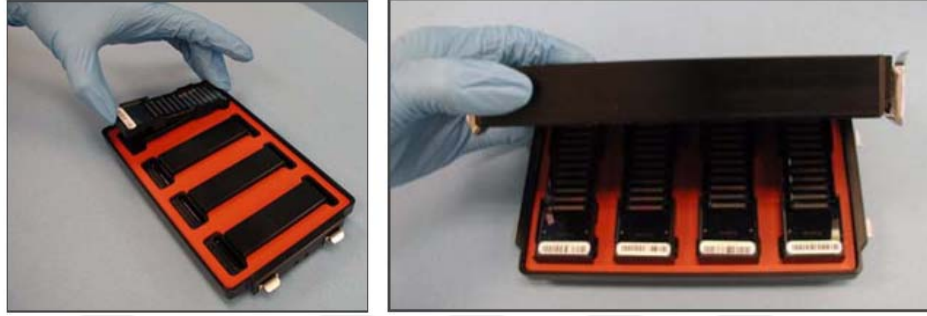
Şekil 3.27. Çipin Hibridizasyon Çemberine Yerleştirilmesi
