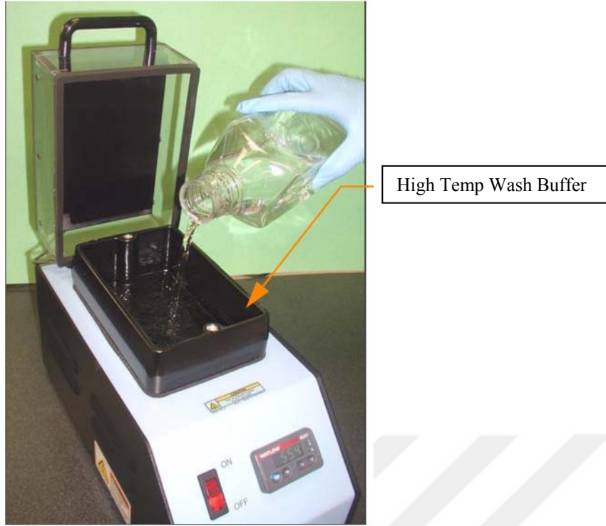
Şekil 3.28. Hybex su banyosuna High Temp Wash Buffer eklenmesi
