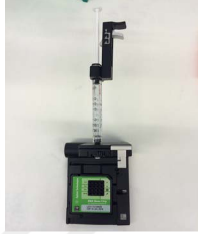
Şekil 3.13. RNA çipinin RNA çip istasyonuna yüklenmesi
