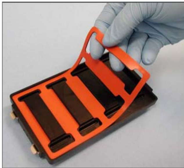
Şekil 3.24. Gasketin Hibridizasyon Çemberine Yerleştirilmesi
