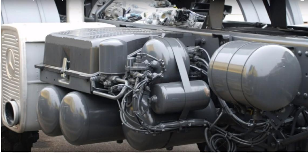
Şekil 3.1. Hava kurutucunun araca montajlanmış hali
