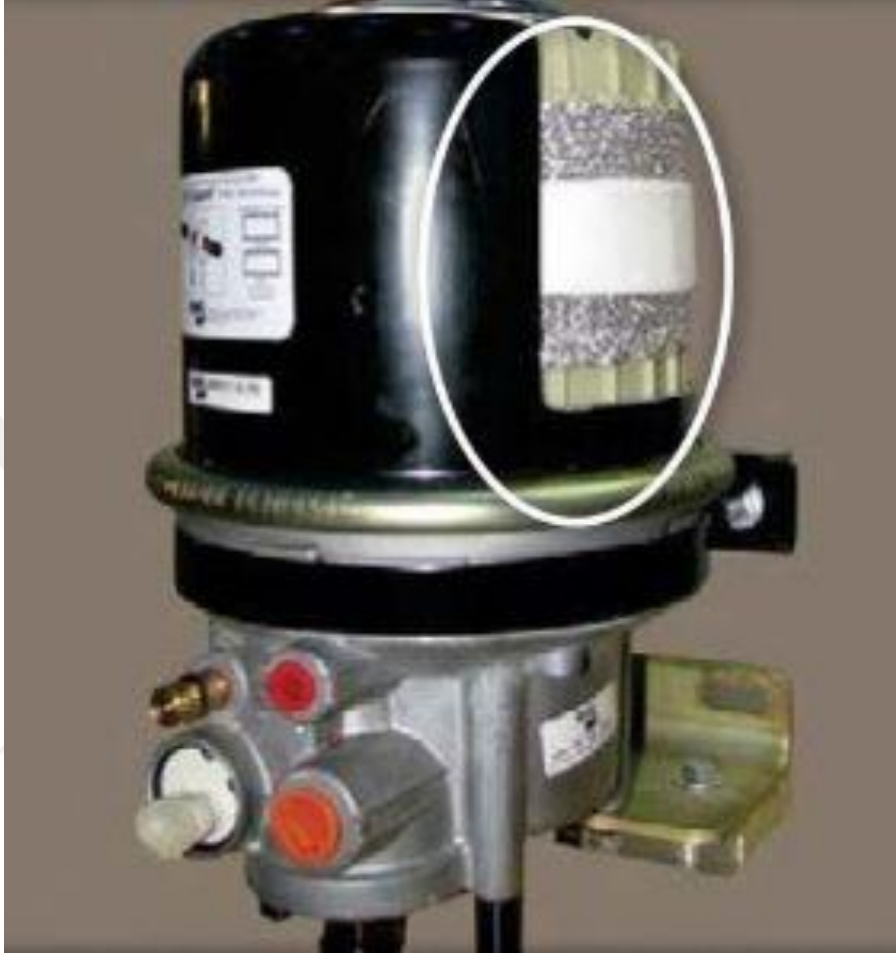
Şekil 2.24. Dufy ve Wright' ın (2016) yazdığı kitaptaki, kartuş içindeki kurutucu granül
