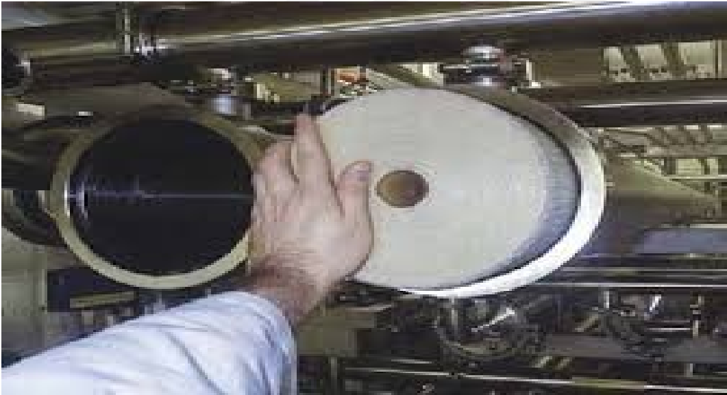
Şekil 3.2.4.5.Paslanmaz çelik koruma içerisinde sarmal membran
