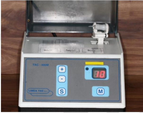
Şekil 3.6. Equia Forte HT kapsüllerin otomatik karıştırıcıya yerleştirilip 10 saniye karıştırılması
