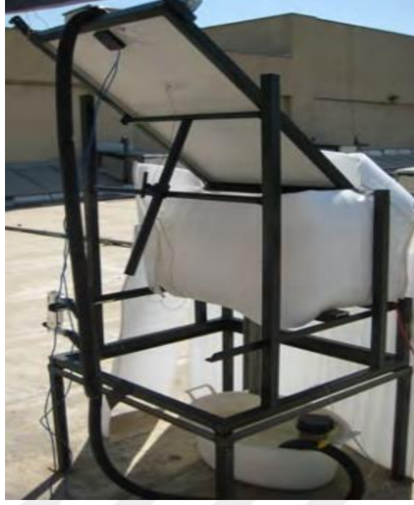
Şekil1.7. Panel ön yüzeyine yapılan su püskürtmeli soğutma sisteminin arkadan görünümü (Kaynak:Hosseini, 2011)
