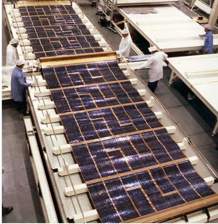
Şekil 2.7. Hubble uzay teleskobunun galyum arsenit panelleri
