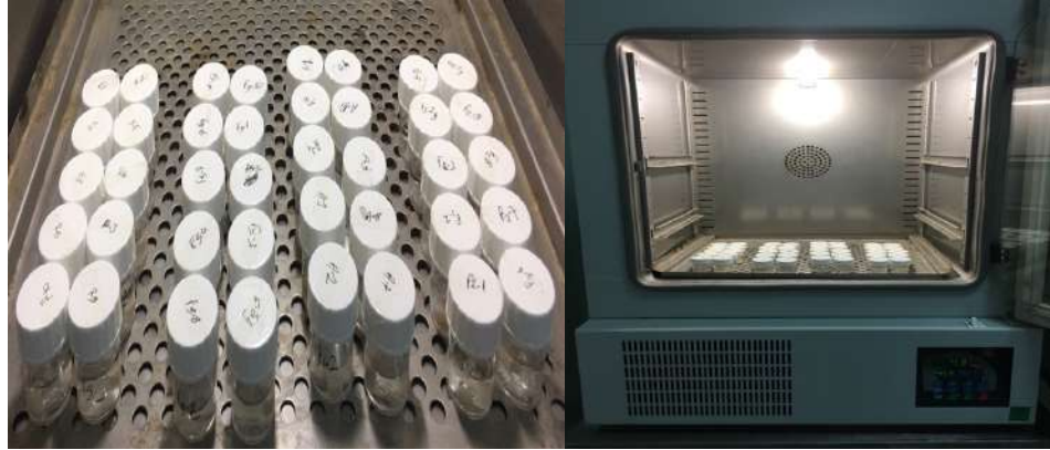
Şekil 3.17: Florid salınım testi için hazırlanan örneklerin etüvde saklanması
