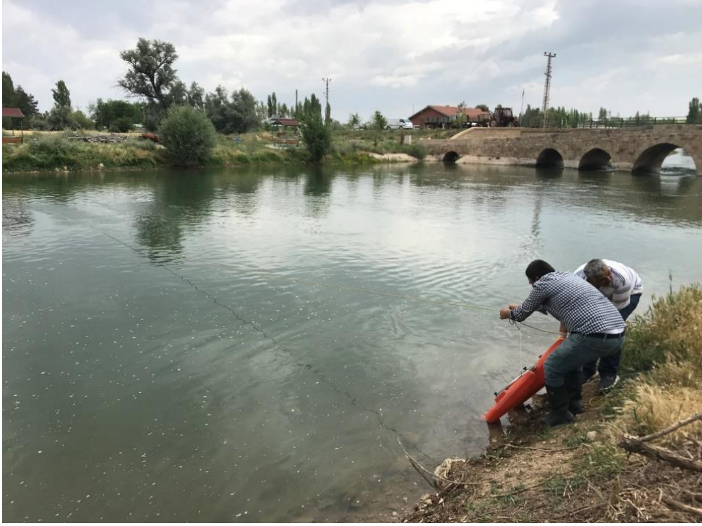
Şekil 4.3. Cihazın kanala yerleştirilmesi
