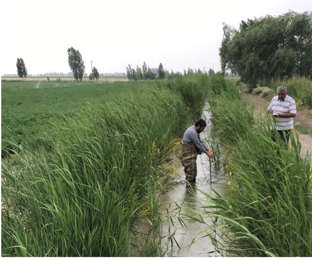
Şekil 4.13. Tersiyer kanallarda muline ile ölçüm yapılması
