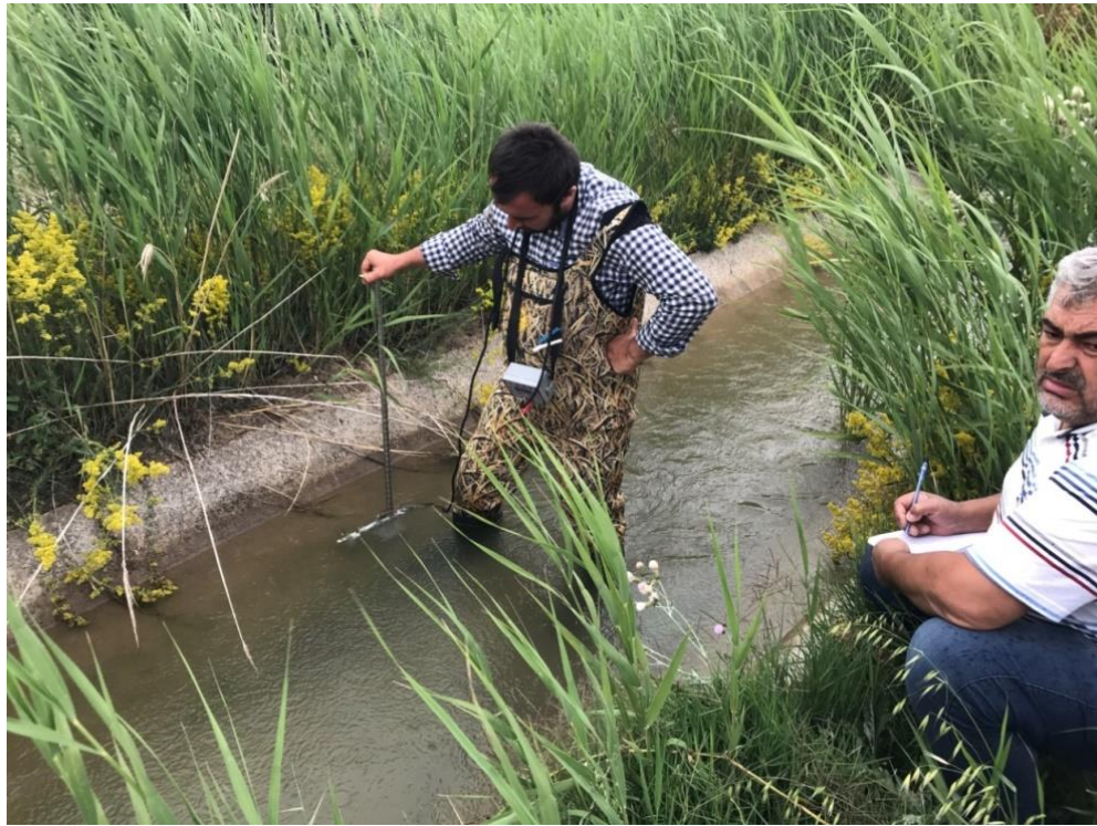
Şekil 4.12. Tersiyer kanallarda muline ile ölçüm yapılması
