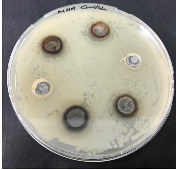
Şekil 4. 12. C. albicans 'a karşı Ag, Cu ,Ag-Cu nanopartiküllerin agar kuyu difüzyon sonucu oluşturdukları inhibisyon zon görüntüleri
