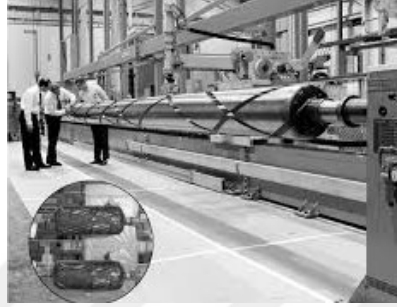
Şekil 2.10. Elyaf sarma yöntemi ile imal edilmiş silindirik boru (Aktaş, 2010).
