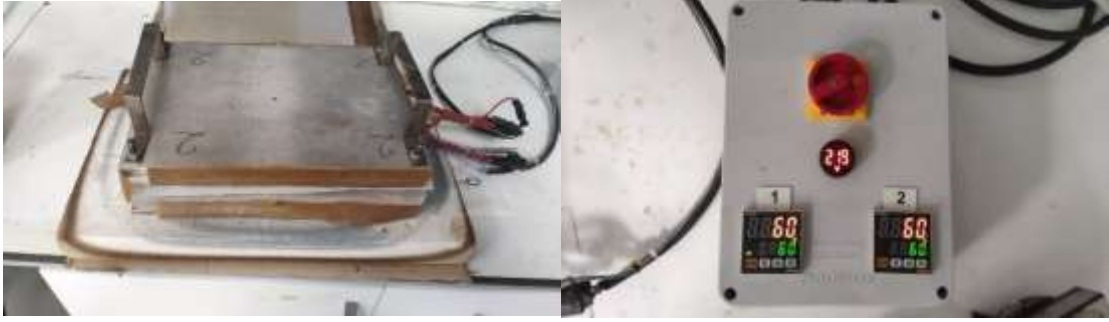
Şekil 3.14. Sert ve Yumuşak Tabakalar ile Alüminyum Plakaların Çift Taraflı Isı Plakasında Yapıştırılması
