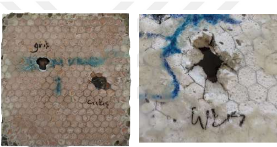
Şekil 4.8. Lokal Hasar Görüntüleri (a: numune 1, sert faz.,b: numune 3, yumuşak faz)
