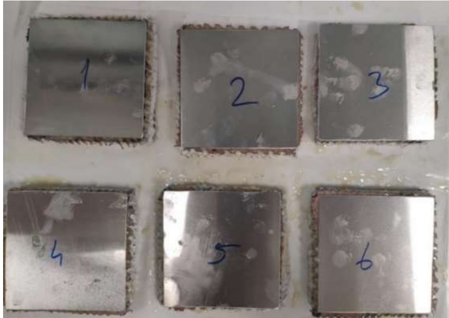
Şekil 3.13. Sert ve Yumuşak Tabakalar ile Alüminyum Plakaların Yapıştırma Öncesi Hazırlığı
