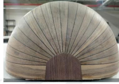
Resim 117. Zenne Ud Ayna Yapıştırılması
