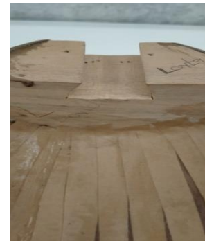
Resim 43. Kırlangıç Geçme Lavta
