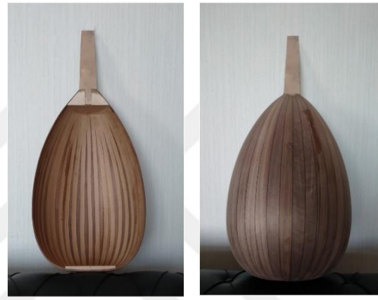
Resim 45. Zenne Ud Sap Montajı
