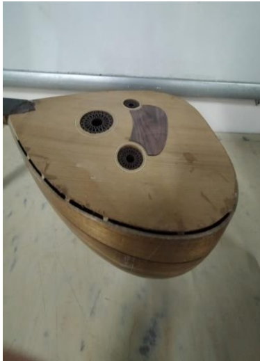
Resim 90. Çocuk Udu Yanlık Fileto Açılması ve Yapıştırılması
