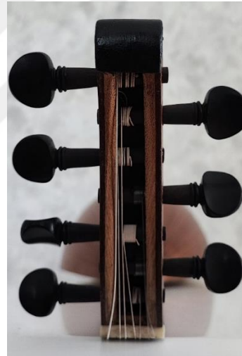
Resim 134. Lavta Tellerin Takılması
