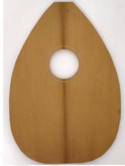
Resim 79. Lavta Ses Delikleri Açılması
