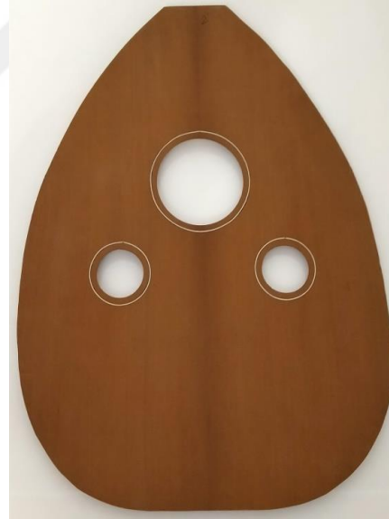
Resim 77. Zenne Ud Ses Delikleri Açılması
