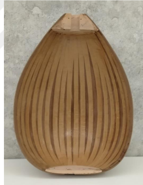
Resim 29. Lavta Teknesi Dilimlere Kâğıt Yapıştırılması
