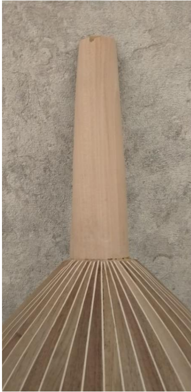
Resim 48. Ud Sap Ovalleştirilmesi
