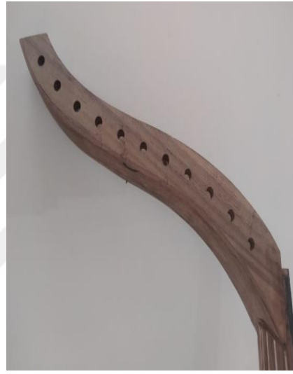
Resim 109. Zenne Ud Burguluk Montajı ve Raybalanması
