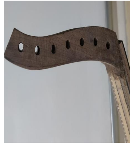
Resim 111. Lavta Burguluk Montajı ve Raybalanması
