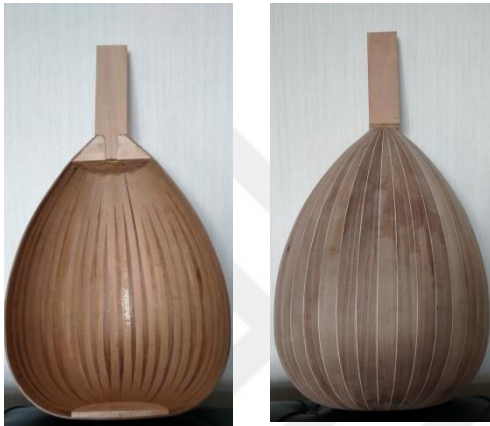
Resim 44. Ud Sap Montajı
