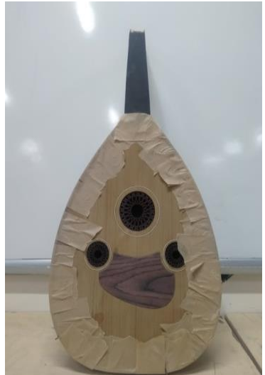
Resim 90. Çocuk Udu Yanlık Fileto Açılması ve Yapıştırılması
