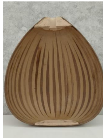
Resim 25. Zenne Ud Teknesi Dilimlere Kâđıt YapıŐtırılması
