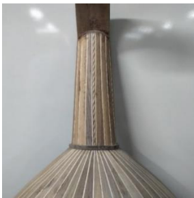
Resim 120. Ud Bilezik Yapıştırılması
