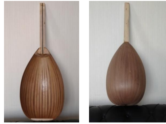
Resim 47. Lavta Sap Montajı
