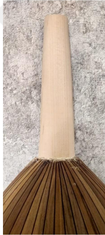
Resim 49. Zenne Ud Sap Ovalleştirilmesi
