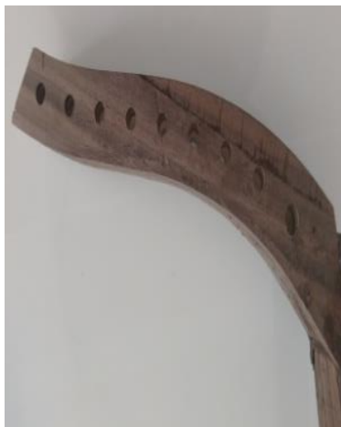
Resim 110. Çocuk Udu Burguluk Montajı ve Raybalanması
