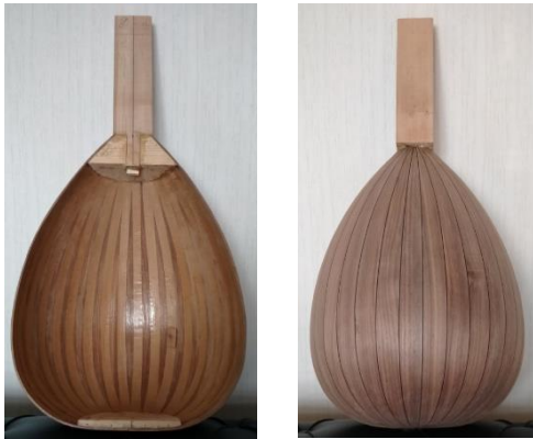
Resim 46. ocuk Udu Sap Montajı
