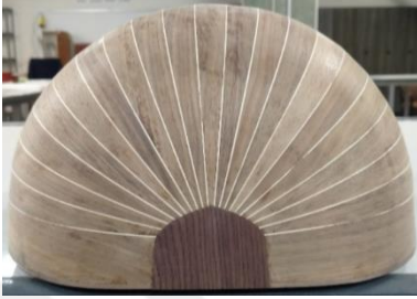
Resim 116. Ud Ayna Yapıştırılması
