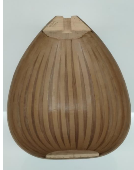
Resim 27. Çocuk Udu Teknesi Dilimlere Kâğıt Yapıştırılması
