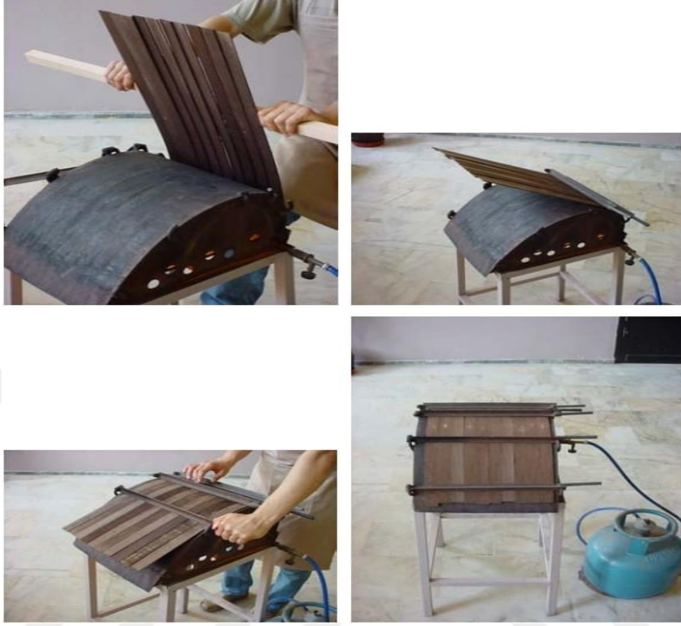
Resim 20. Tekne Dilimlerinin Ütü İle Bükülmesi (Pamukçu, 2013, s.30)
