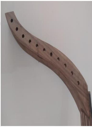
Resim 108. Ud Burguluk Montajı ve Raybalanması
