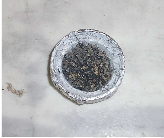
Şekil 3.20. Presleme öncesi partikül karışım (p50d50)
