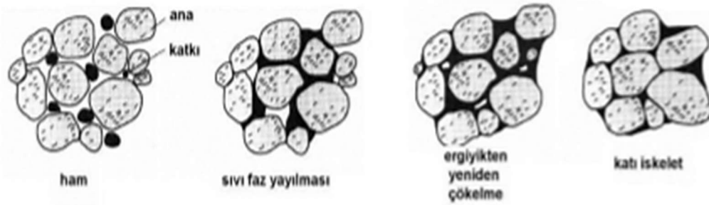
Şekil 3.11. Sıvı fazlı sinterlemenin kavramsal aşamaları (Öztürk ve İcin, 2015))
