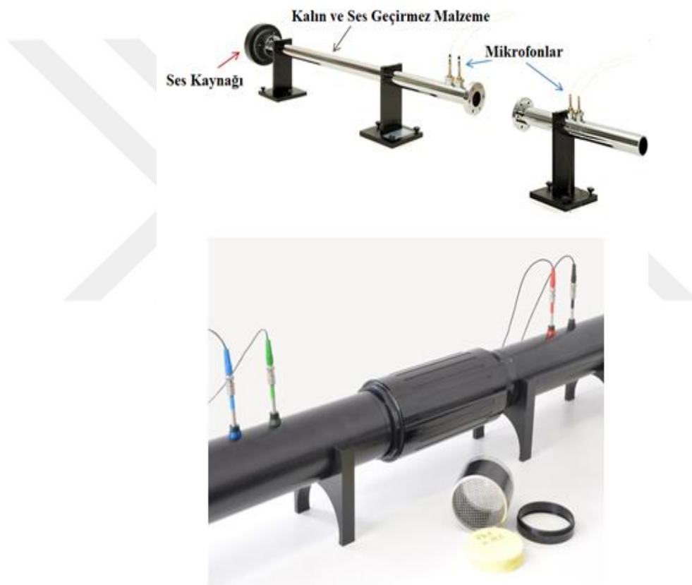
Şekil 3.5. Örnek empedans tüpü görselleri (AED-Acoustic Engineering Dresden)
