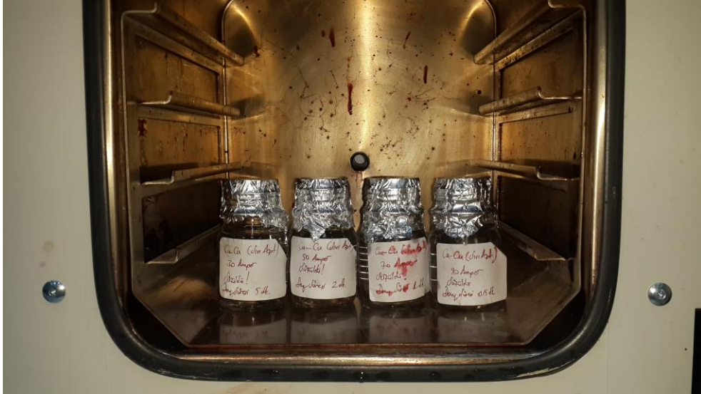
Şekil 3.18. Nanoparçacık karışımı sıvıların fırın içerisinde buharlaştırılması
