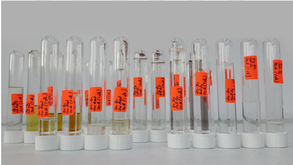
Şekil 4.3. Süzme işlemi bitmiş sıvı içerisindeki nanoparçacıklar
