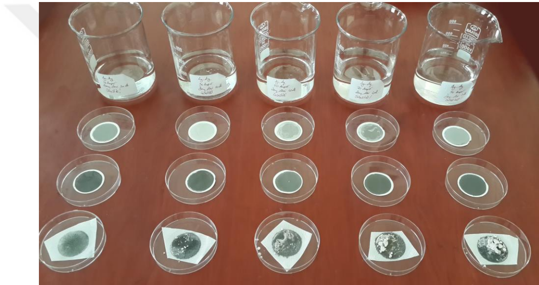
Şekil 3.17. Saf su içerisinde farklı akım değerlerinde üretilen gümüşün süzme sonrası filtre görüntüsü
