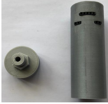
Şekil 3.42 3D yazıcı ile üretilen mekanik muhafaza modeli
