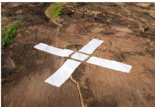
Şekil 3.4. Yer Kontrol Noktaları Zemin İşaretleri
