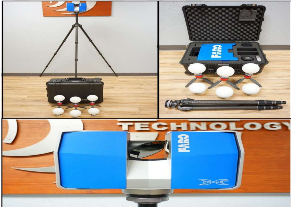
Şekil 4.5. Faro Focus3D X 330 Lazer Tarama Tarayıcı (Faro Tech.)
