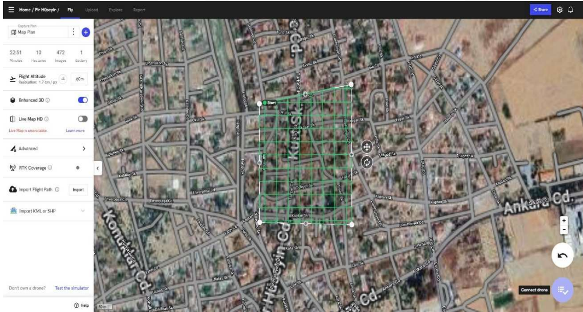
Şekil 4.4. DroneDeploy Flight Uçuş Planlama Ekranı
