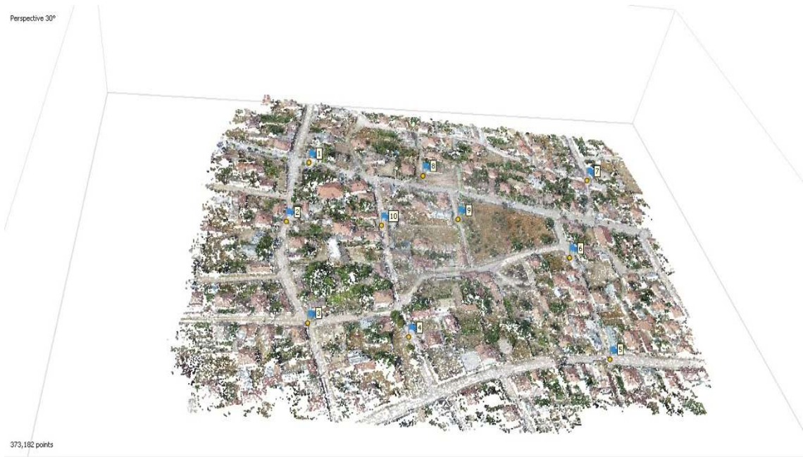
Şekil 4.10. YKN' lerin Gösterildiği Seyrek Nokta Bulutu
