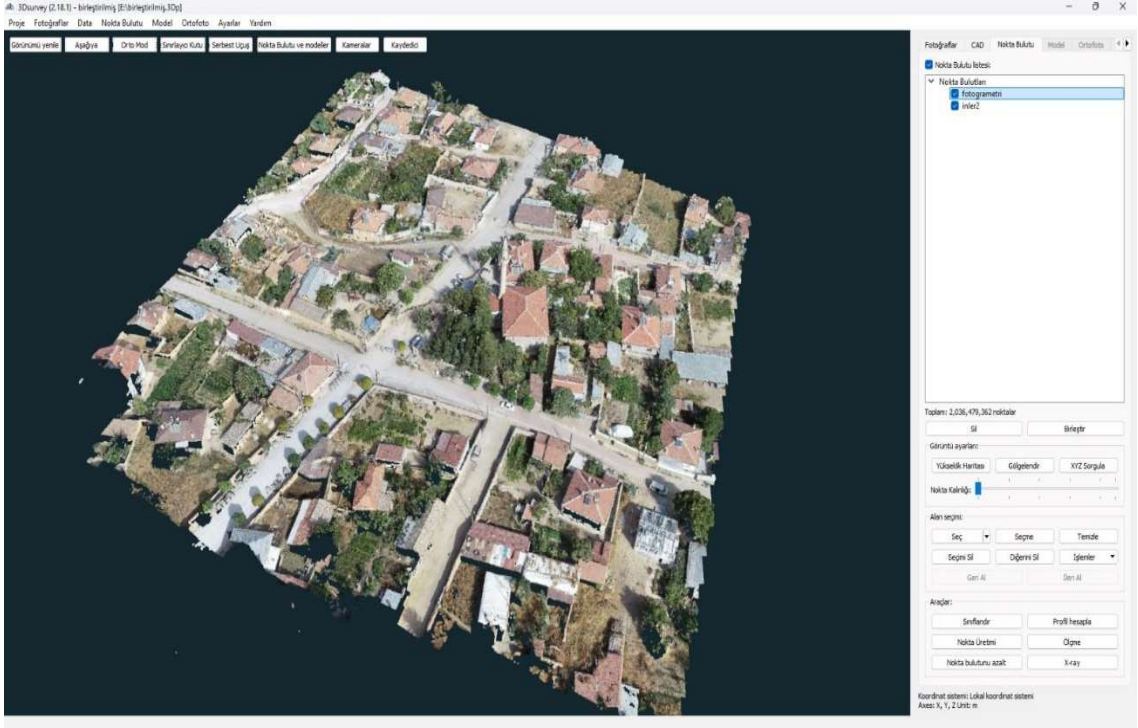
Şekil 4.13. Nokta Bulutları Birleştirildikten Sonra Oluşan Yoğun Nokta Bulutu (2.036.479.362 Nokta)
