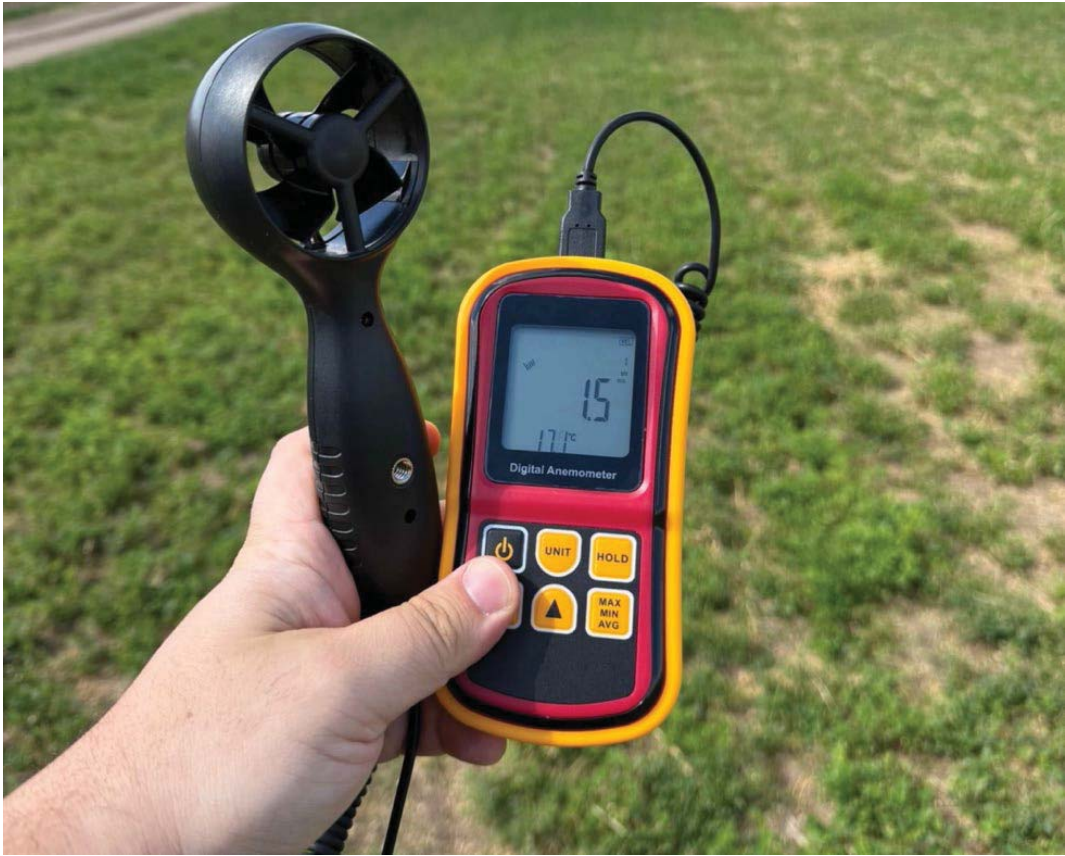
Şekil 3.1. Saha testlerinde anemometre ile rüzgar ölçüm sonuçları
