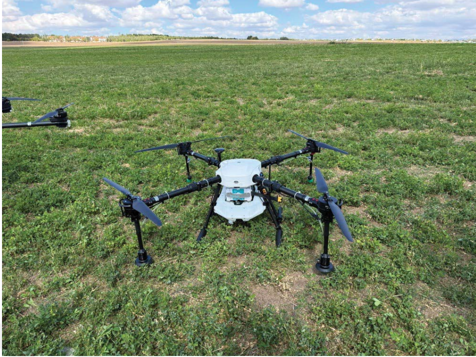
Şekil 3.2. Drone-1 10 litre kapasiteli AR-GE amaçlı üretilmiş drone
