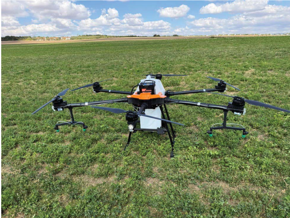
Şekil 3.3. Drone-2 Robosys üretimi KD-30 model 30 litre kapasiteli drone
