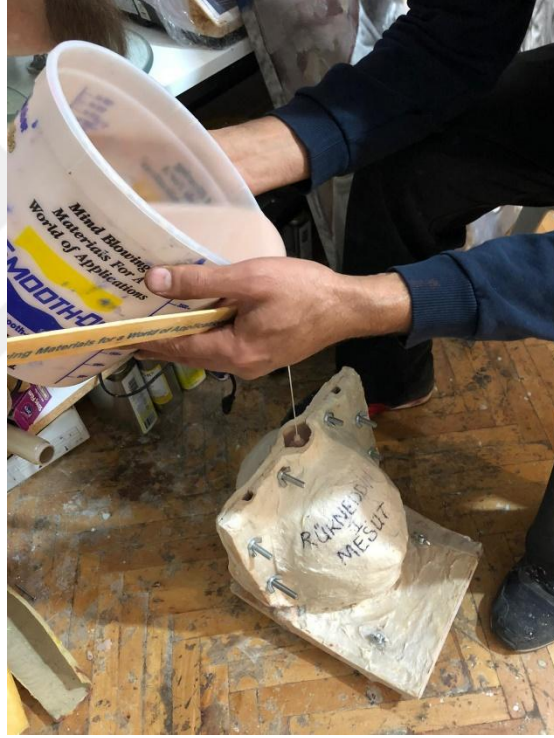
Resim.24: Dış Kalıbın içerisine silikon dökme aşaması
