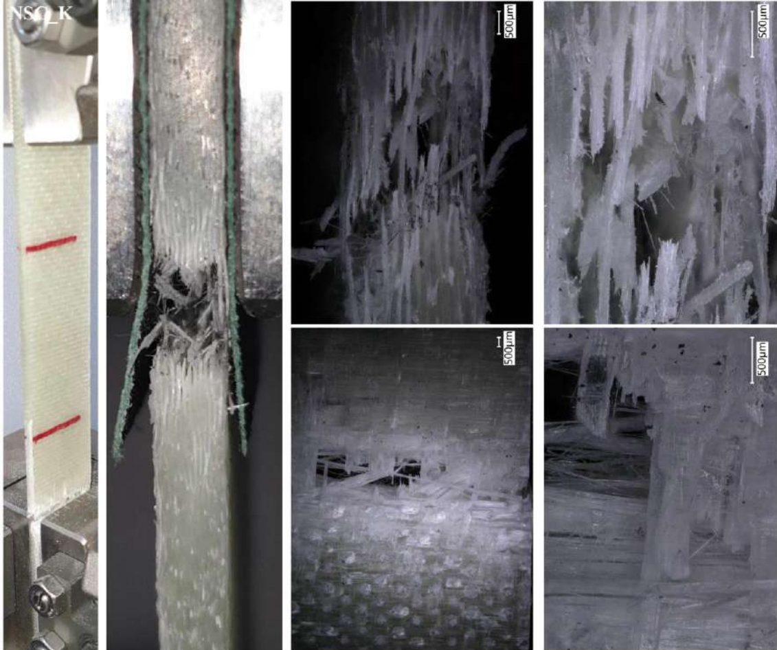
Şekil 5.21. Nano takviyeli cam (NSC_K) test numunesinin çekme testi sonrası hasar görüntüleri
