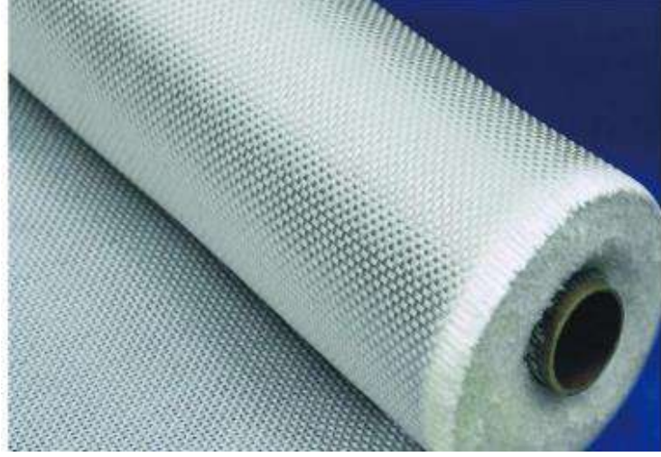
Şekil 3.7. Cam elyaf dokuma kumaş
