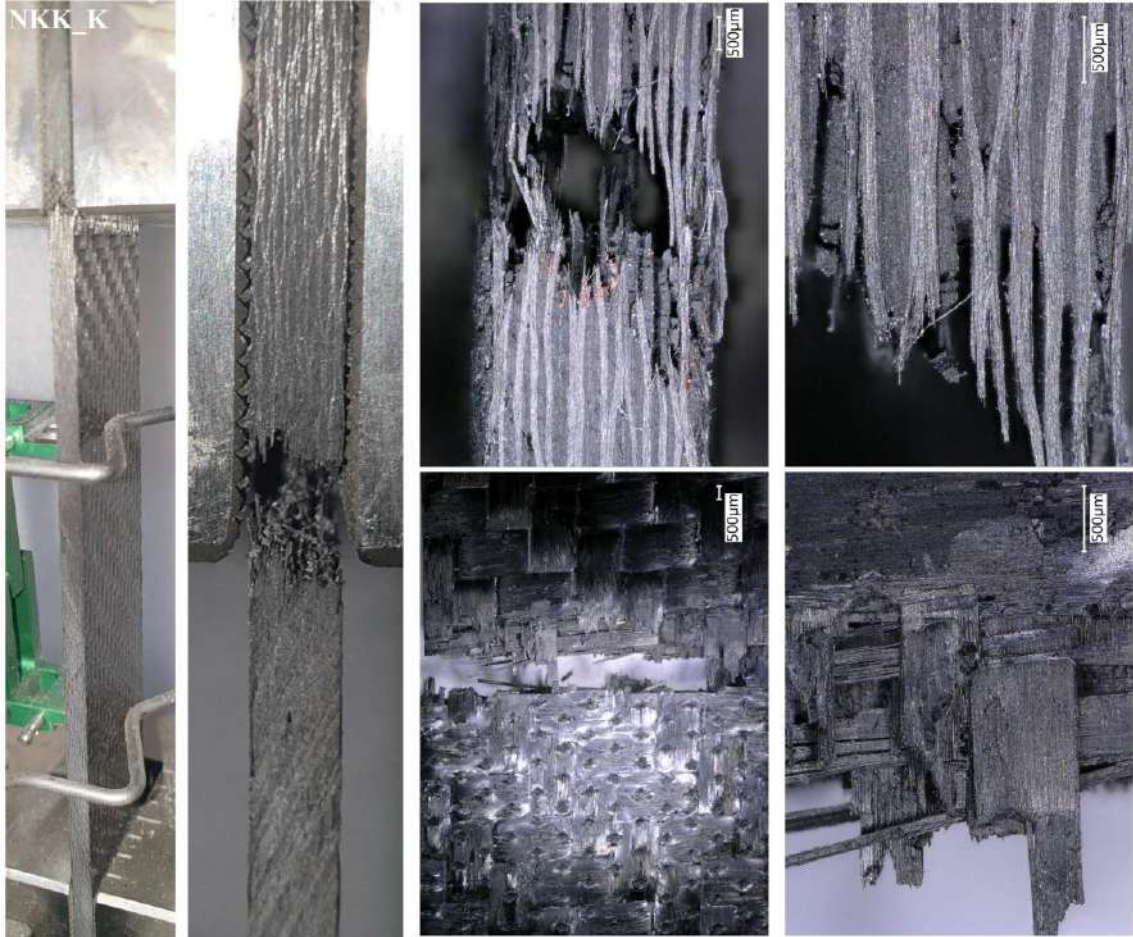
Şekil 5.23. Nano takviyeli karbon kompozit (NKK_K) test numunesinin çekme testi sonrası hasar görüntüleri
