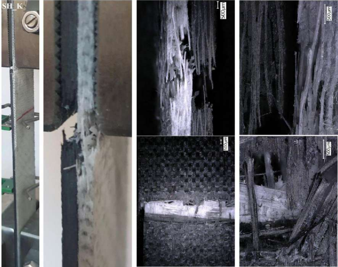
Şekil 5.24. Saf hibrit kompozit (SH_K) test numunesinin çekme testi sonrası hasar görüntüleri
