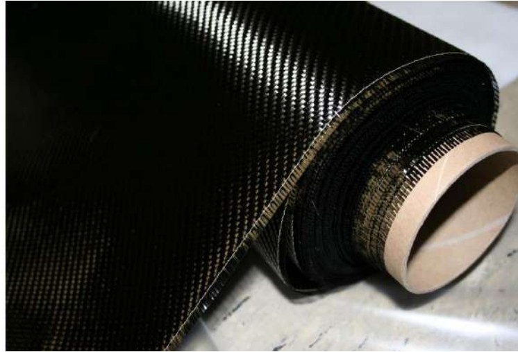
Şekil 3.8. Karbon elyaf dokuma kumaş
