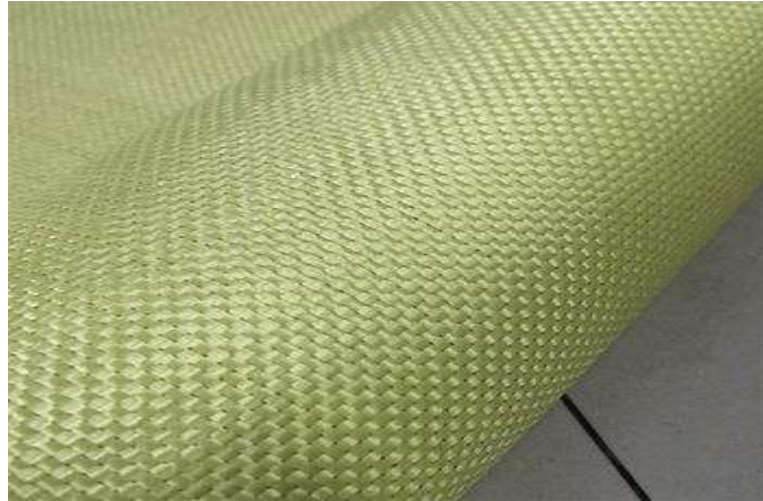
Şekil 3.9. Aramid elyaf dokuma kumaş
