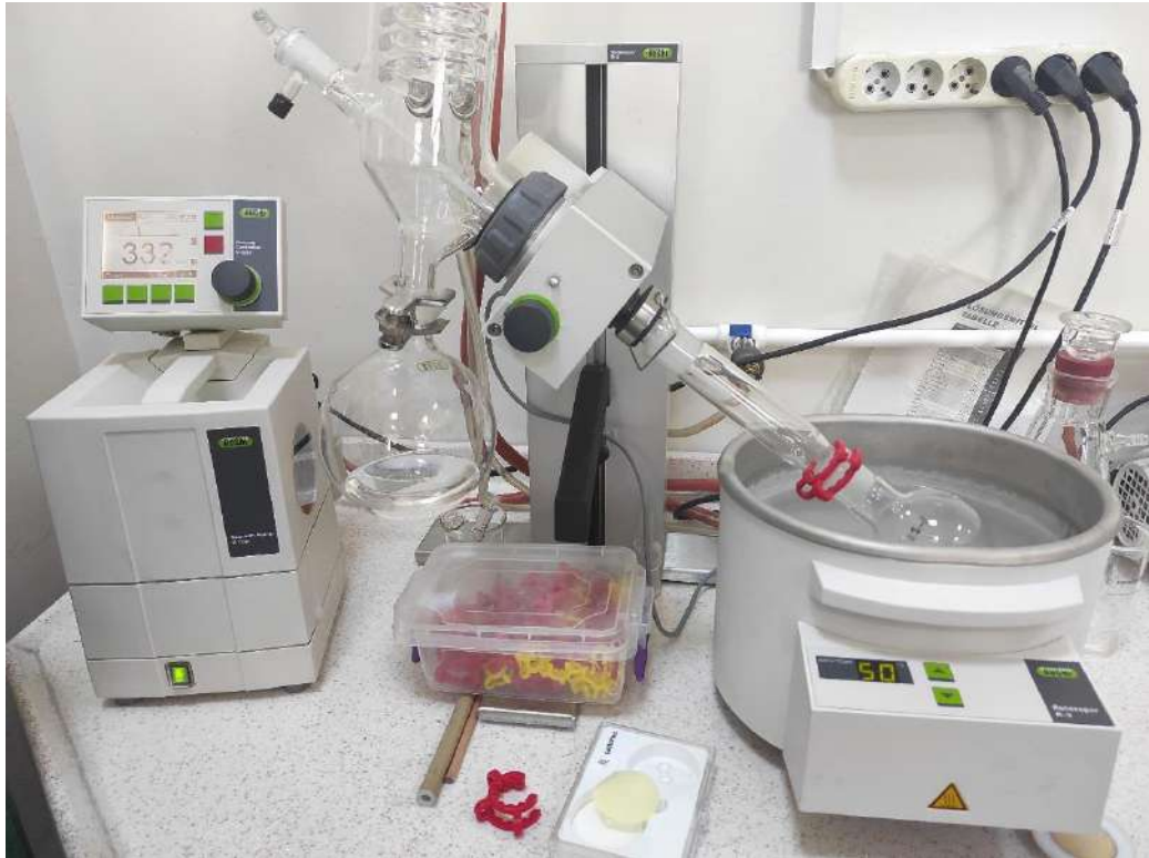
Şekil 3.54: Evaporatörde hacim azaltma
