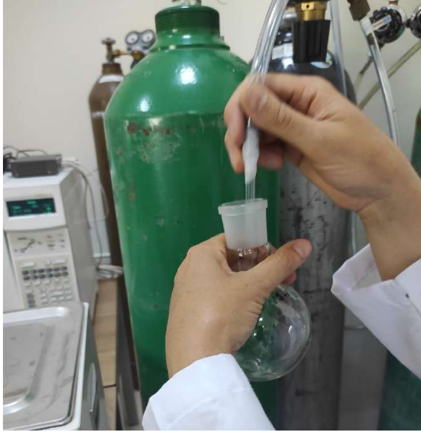
Şekil 3.55: Azot gazıyla hacim azaltma
