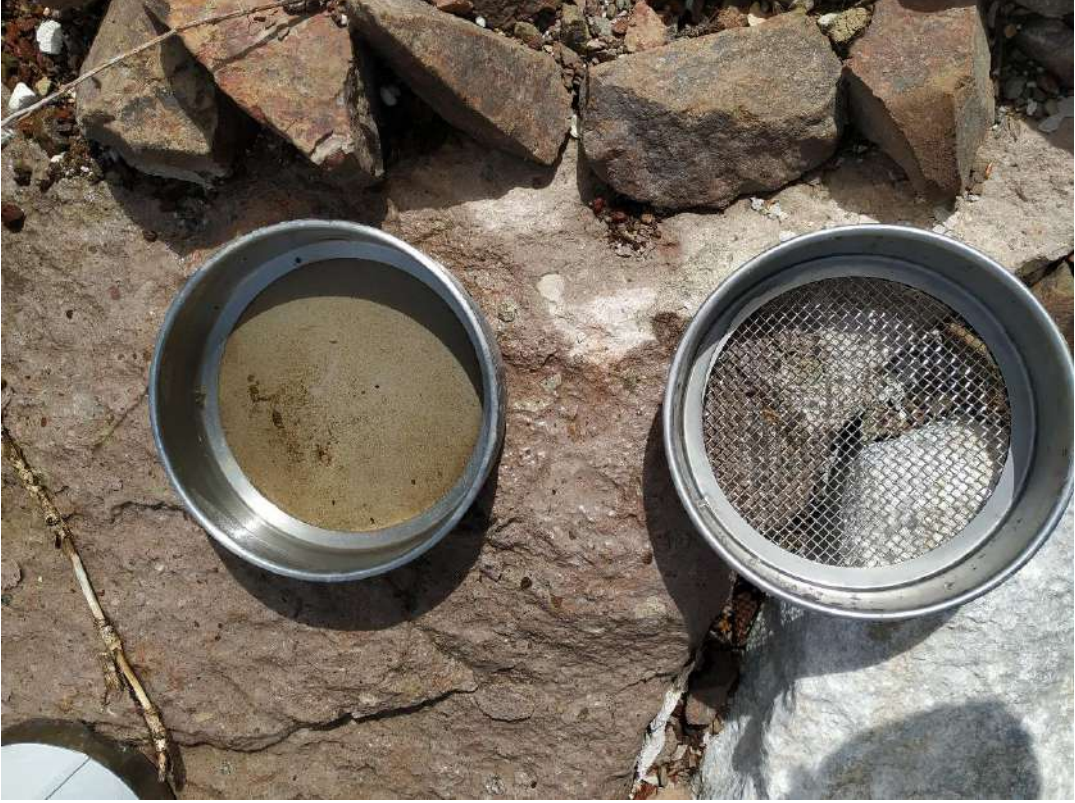
Şekil 3.37: Numune alma işlemi sırasında kullanılan 5 mm ve 20 µm'lik çelik elekler
