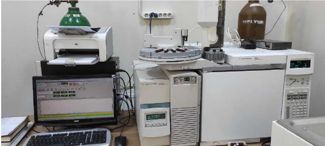
Şekil 3.57: Numunenin GC-MS ile analizi
