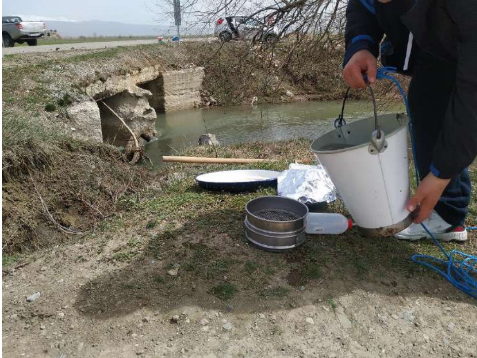
Şekil 3.36: Toplanan su numunelerinin eleklerden geçirilmesi
