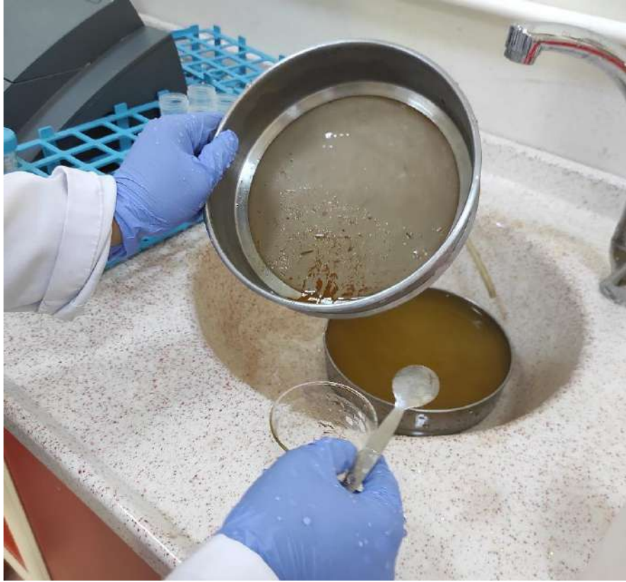
Şekil 3.43: Yoğunluk ayırımı işlemi öncesinde süzülen numuneler
