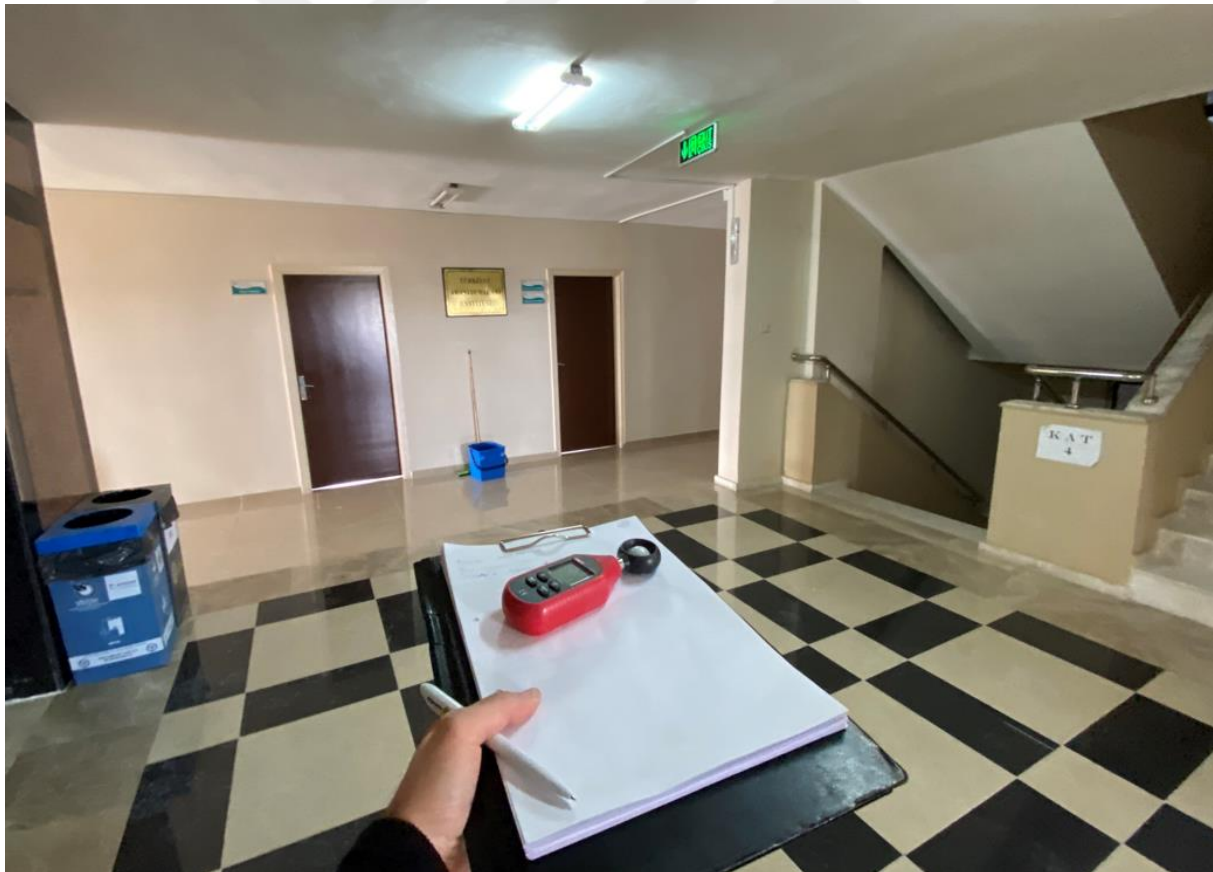
Şekil 5.63. Aydınlatma lüx ölçüm görüntüsü
