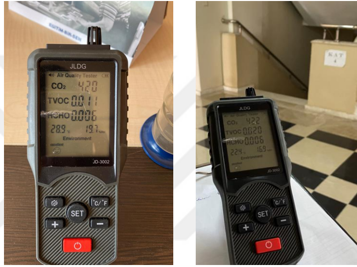
Şekil 5.45. 305 numaralı oda ve 4. kat koridor hava kalitesi ölçüm görüntüsü
