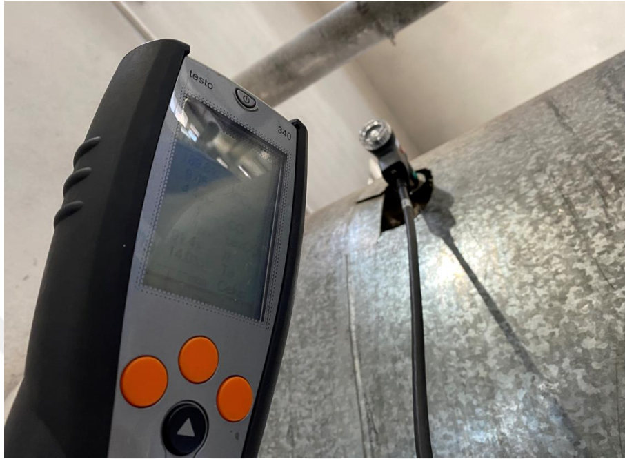
Şekil 5.35. Baca gazı analiz görüntüleri
