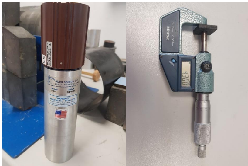
Şekil 3.5. Gama iletiminin ölçümü için kullanılan gama dedektörü ve numune kalınlıklarının teker teker ölçüldüğü mikrometre
