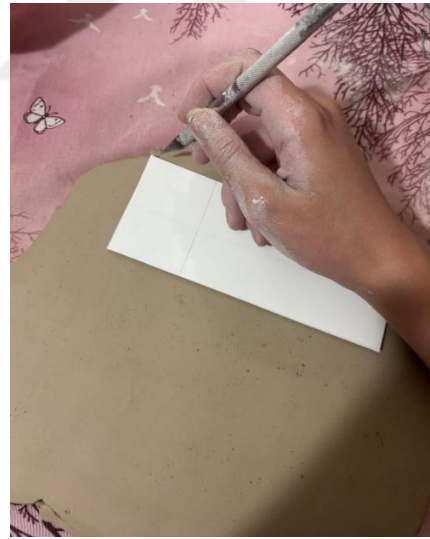
Şekil 3.10. Seramik çamurundan yapılan plakayı şablonlara göre kesme işlemi. Fotoğraf: Miray Gürol Öz
