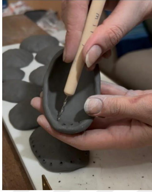
Şekil 3.4. Elle şekillendirilmiş ve deri sertliğine getirilmiş parçaların delik açma aşaması. Fotoğraf: Miray Gürol Öz
