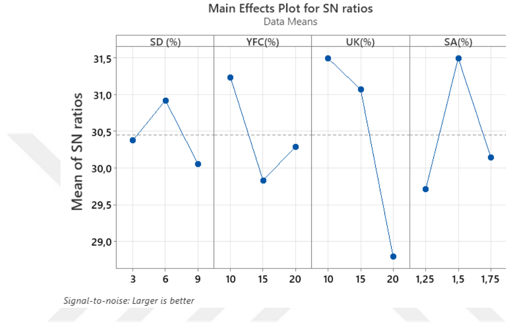
Şekil 5.6. 14 günlük ortalama standart basınç dayanımı için ortalama S/N grafiği
