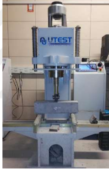
Şekil 3.28. Numunelere eğilme dayanımı deneyi yapılması
