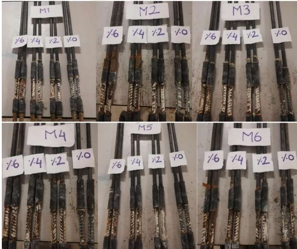
Şekil 4.38. M1-M6 arası serilerin pullout deneyi sonrası donatı görselleri
