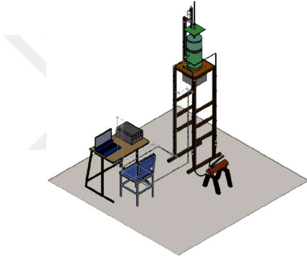
Şekil 3.33. Pullout deney düzeneği
