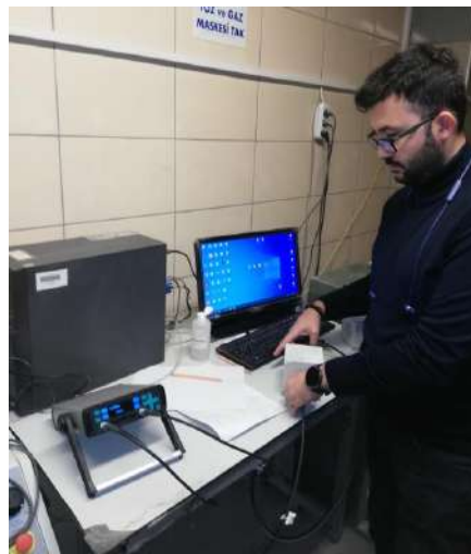
Şekil 3.27. Numunelere ultra ses geçiş hızı deneyi yapılması
