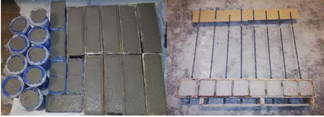
Şekil 3.19. Hazırlanan karışımların kalıplara yerleştirilmesi
