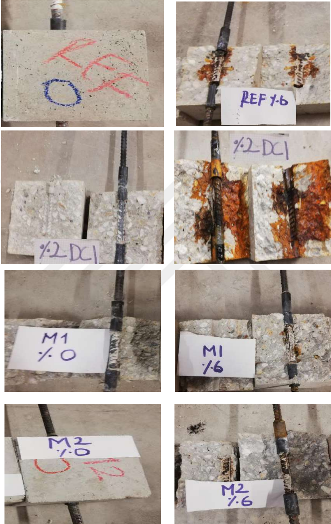
Şekil 4.27. REF, %2 DCI, M1 ve M2 serilerinin K0 ve K6 durumlarında pullout deneyi sonrası görselleri
