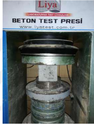
Şekil 3.26. Numune üzerinde basınç dayanım testinin uygulanışı
