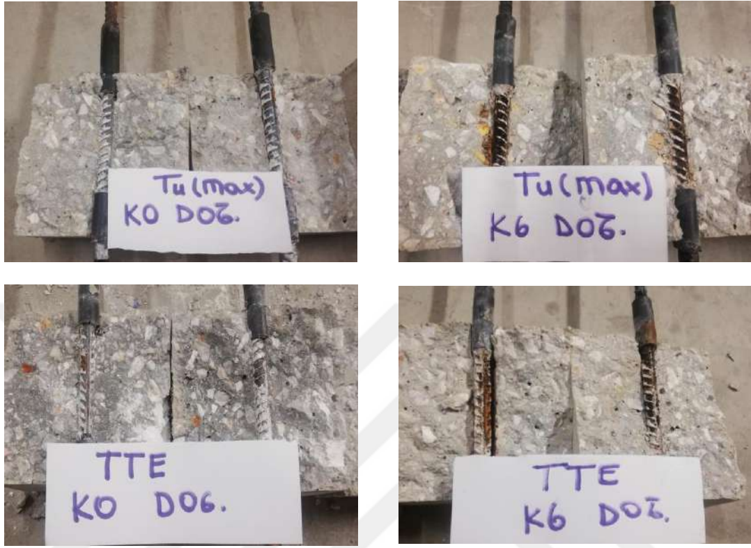
Şekil 4.30. M8 ve doğrulama serilerinin K0 ve K6 durumlarında pullout deney sonrası görselleri
