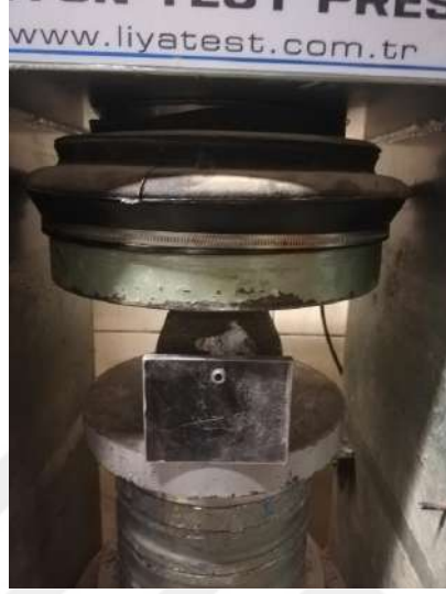
Şekil 3.29. Numunelere yarmada çekme dayanımı deneyi yapılması
