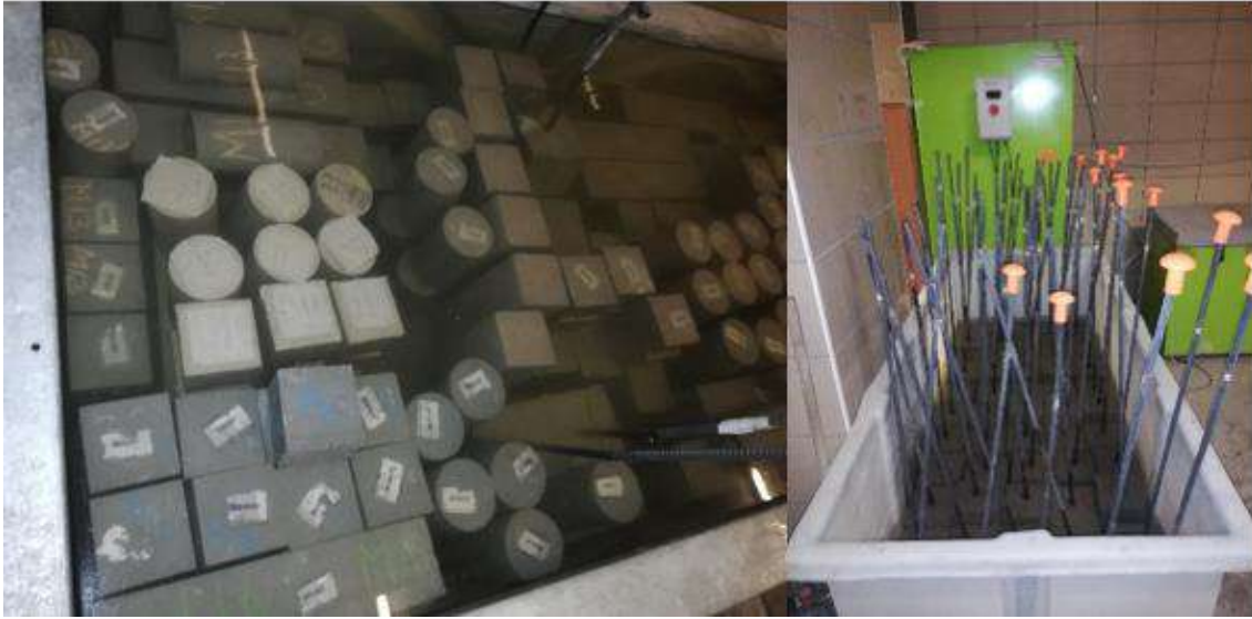
Şekil 3.20. Numunelere kür işlemi uygulanması
