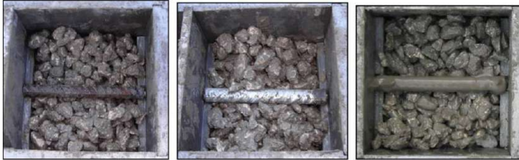
Şekil 2.11. İnce agregasız farklı kaplama tiplerinde üretilen numuneler (Tittarelli vd., 2013)
