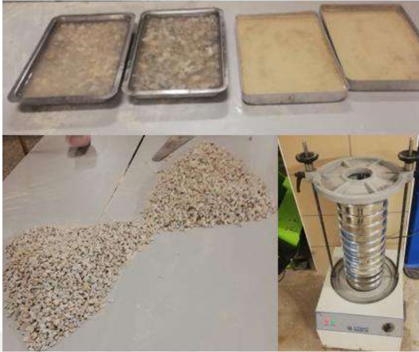
Şekil 3.4. Agreganın su emme/birim ağırlık tayini ve granülometri deneylerinin yapılması
