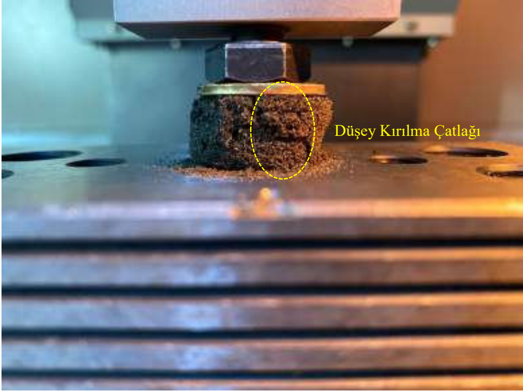
Ŗekil E1.7. İ6F400 Basma Numunesi
