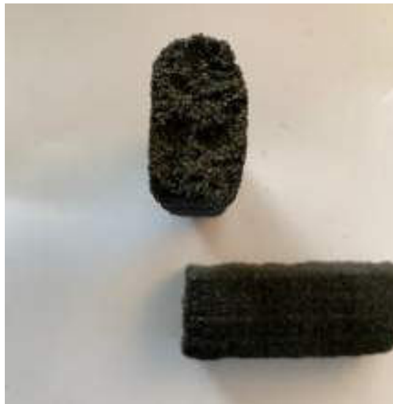
Şekil 4.17. K5F300 Eđme Numunesi Kırık Yüzeyi
