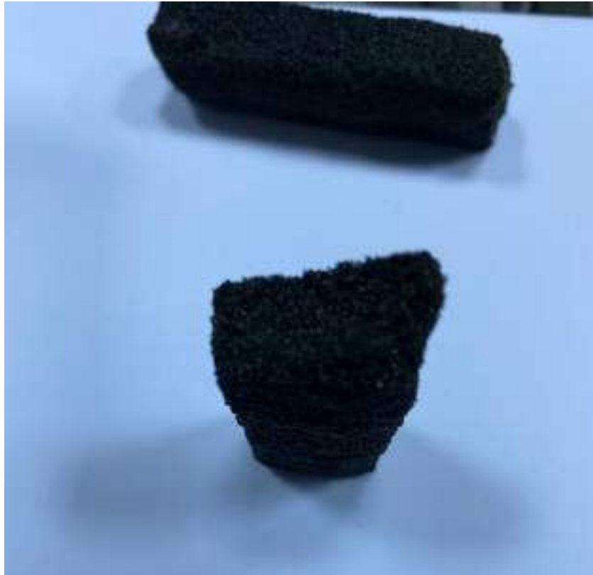
Şekil E2.10. İ5F300 Eğme Numunesi Kırık Yüzey
