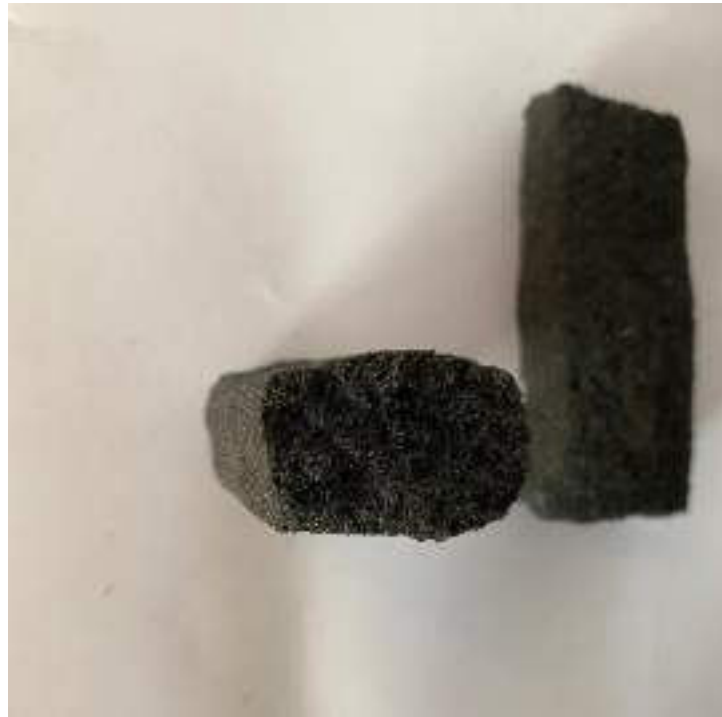
Şekil E2.4. K7F300 Eğme Numunesi Kırık Yüzey
