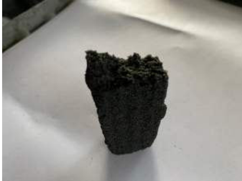
Şekil E2.12. İ6F300 Eğme Numunesi Kırık Yüzeyi
