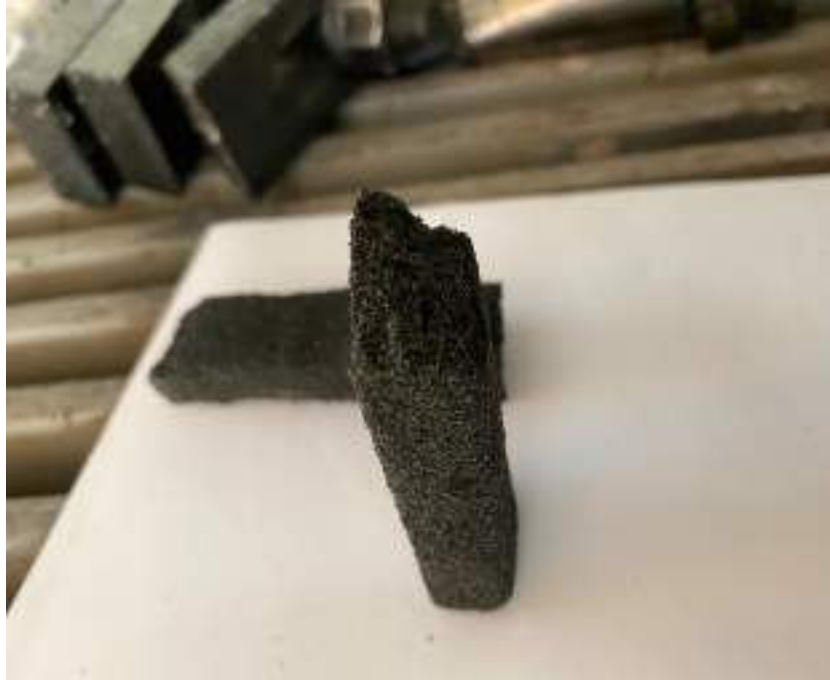
Şekil E2.2. K6F300 Eğme Numunesi Kırık Yüzey
