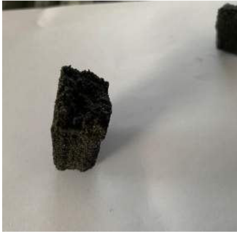
Şekil E2.8. K6F500 Eğme Numunesi Kırık Yüzey
