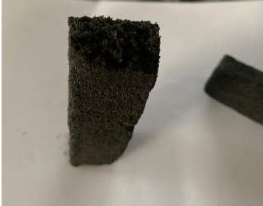
Şekil E2.16. İ6F400 Eğme Numunesi Kırık Yüzey
