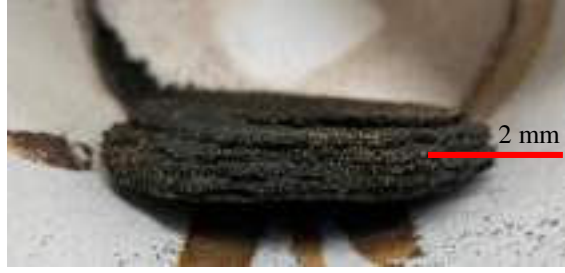
Şekil 4.43. Katman Kalınlığı 2 mm olan Numune
