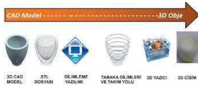
Şekil 2.1. Genelleştirilmiş katmanlı imalat prosesi (Kara, 2013)
