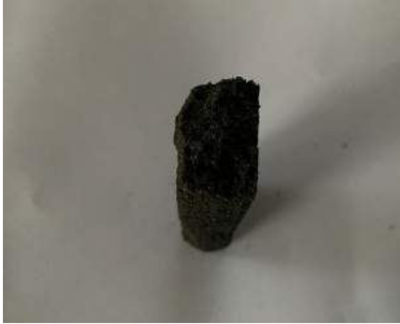
Şekil E2.18. İ6F500 Eğme Numunesi Kırık Yüzey
