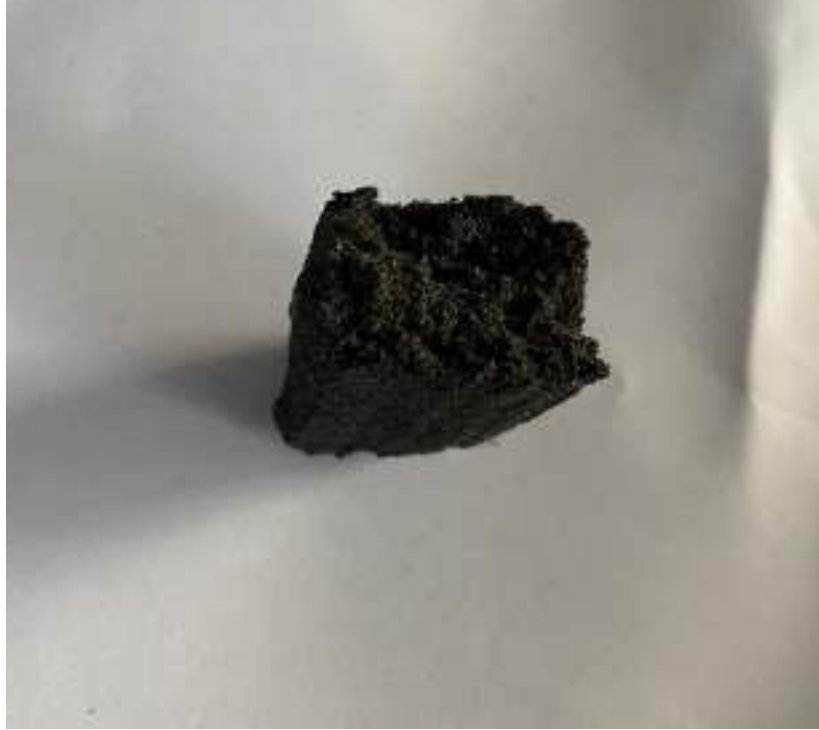
Şekil E2.14. İ7F300 Eğme Numunesi Kırık Yüzey
