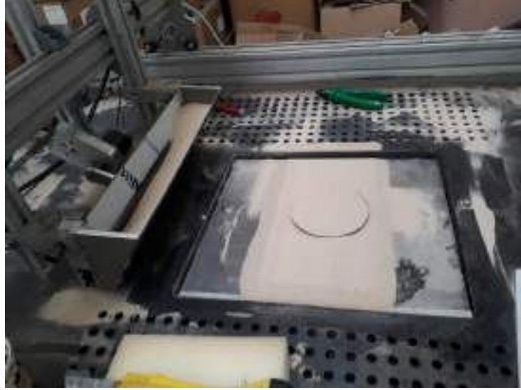
Şekil 3.11. Kum Serici İlerlemesi ve Katman Sayısının Belirlenmesi
