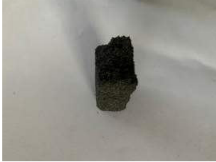
Şekil E2.6. K6F400 Eğme Numunesi Kırık Yüzeyi
