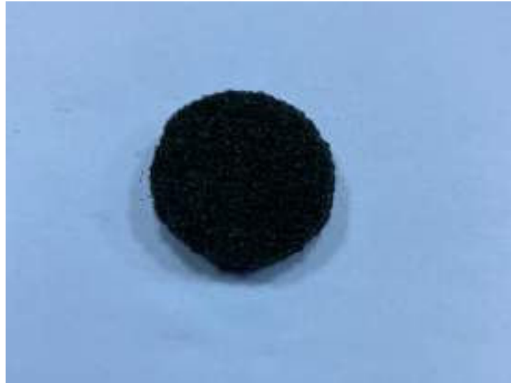
Şekil 4.11. K6F500 Numunesi Test Sırasında Ayrılan Tabaka
