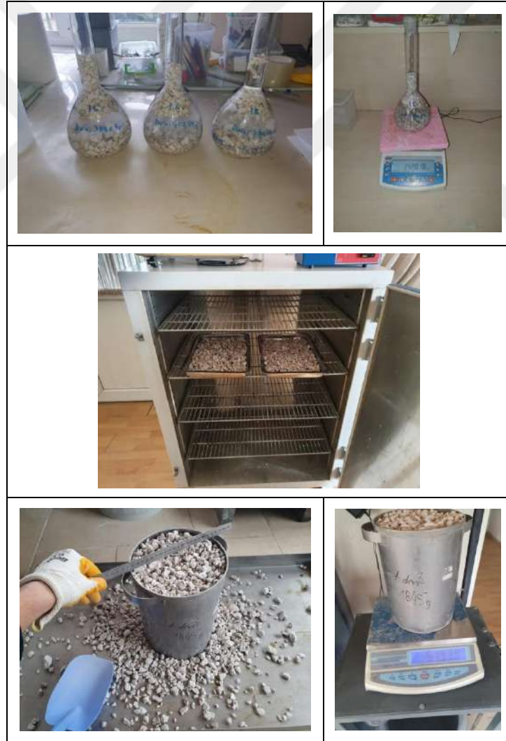
Şekil 3.2. Hafif agregaların gevşek ve sıkışık yığın yoğunluğu (birim ağırlık) , tane yoğunluğu (özgül ağırlık) ve su emme oranı deneyleri
