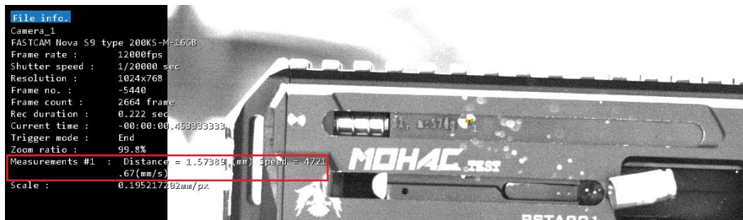
Şekil 3.20 Sönümlü Silah Mek. Sönüm Mekanizmasına Deneysel Çarpma Hızı
