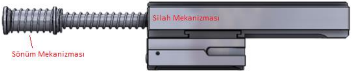
Şekil 3.16 Sönüm Mekanizmasının Montajlanmış Hali
