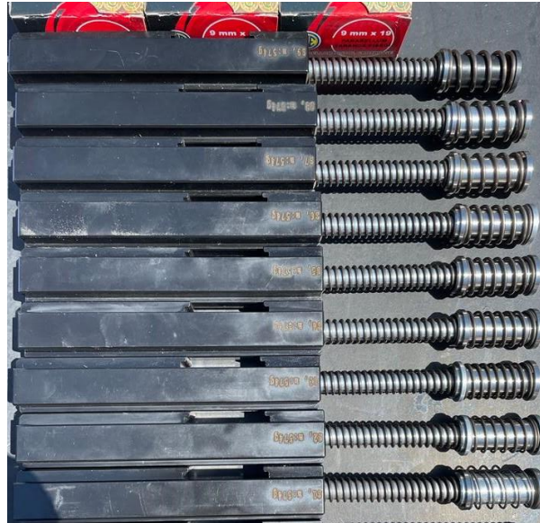
Şekil 3.5 Farklı Sönüm Yaylarına Sahip Mekanizma Blokları
