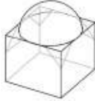
Şekil- 22. Duvar örgüsü içine yerleşen düzlem üçgen
