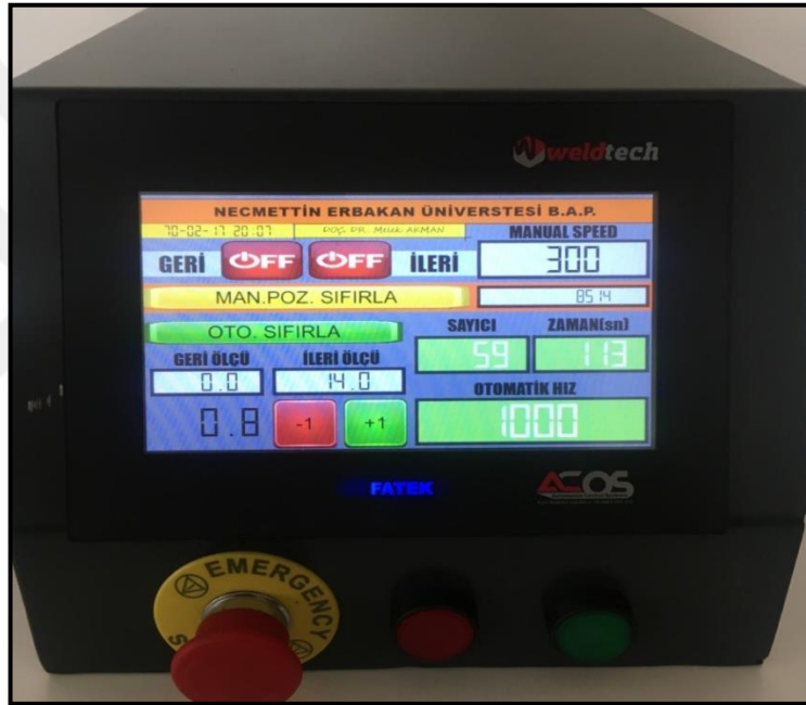
Şekil 3. 2. Döngüsel yorgunluk test cihazı kullanım ayarlarının yapıldığı kontrol ünitesi
