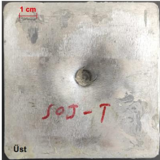
Şekil 4.12. T1 kompozit malzemenin 50 J'lük darbe enerjisine karşılık elde edilen, kuvvet-zaman, kuvvet-deplasman, enerji-zaman grafikleri ile darbelenmiş kompozit malzemenin üst, alt ve kesit görüntüleri
