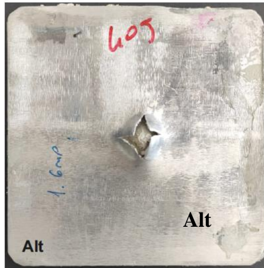
Şekil 4.4. T0 kompozit malzemenin 40 J'lük darbe enerjisine karşılık elde edilen, kuvvet-zaman, kuvvet-deplasman, enerji-zaman grafikleri ile darbelenmiş kompozit malzemenin üst, alt ve kesit görüntüleri
