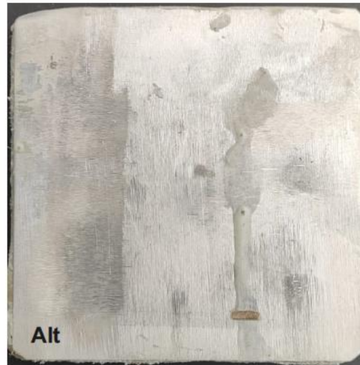
Şekil 4.9. T1 kompozit malzemenin 20 J'lük darbe enerjisine karşılık elde edilen, kuvvet-zaman, kuvvet-deplasman, enerji-zaman grafikleri ile darbelenmiş kompozit malzemenin üst, alt ve kesit görünüşleri
