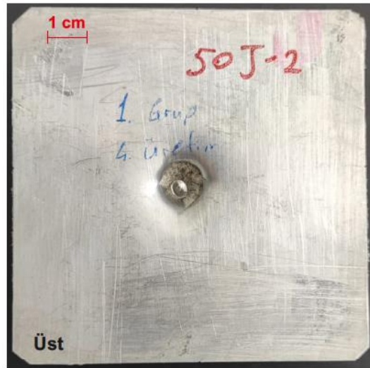
Şekil 4.5. T0 kompozit malzemenin 50 J'lük darbe enerjisine karşılık elde edilen, kuvvet-zaman, kuvvet-deplasman, enerji-zaman grafikleri ile darbelenmiş kompozit malzemenin üst, alt ve kesit görünümleri
