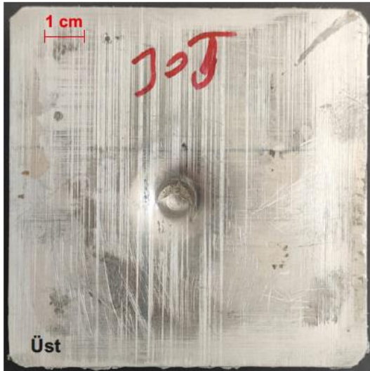
Şekil 4.3. T0 kompozit malzemenin 30 J'lük darbe enerjisine karşılık elde edilen, kuvvet-zaman, kuvvet-deplasman, enerji-zaman grafikleri ile darbelenmiş kompozit malzemenin üst, alt ve kesit görüntüleri
