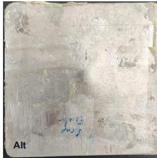
Şekil 4.26. T3 kompozit malzemenin 50 J'lük darbe enerjisine karşılık elde edilen, kuvvet-zaman, kuvvet-deplasman, enerji-zaman grafikleri ile darbelenmiş kompozit malzemenin üst, alt ve kesit görünüşleri
