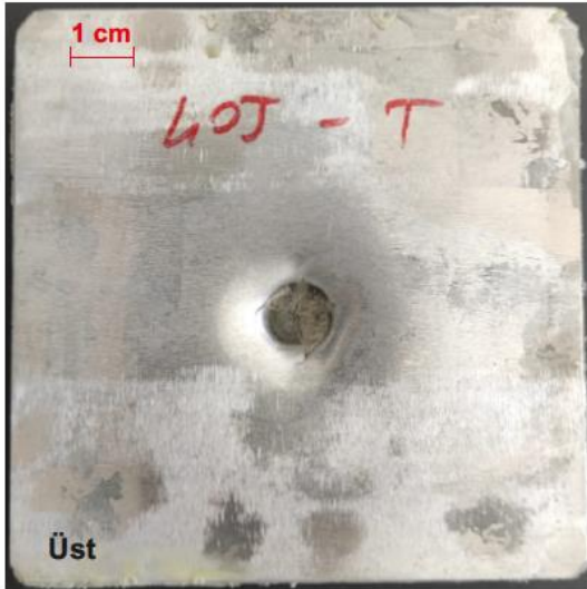
Şekil 4.11. T1 kompozit malzemenin 40 J'lük darbe enerjisine karşılık elde edilen, kuvvet-zaman, kuvvet-deplasman, enerji-zaman grafikleri ile darbelenmiş kompozit malzemenin üst, alt ve kesit görüntüleri
