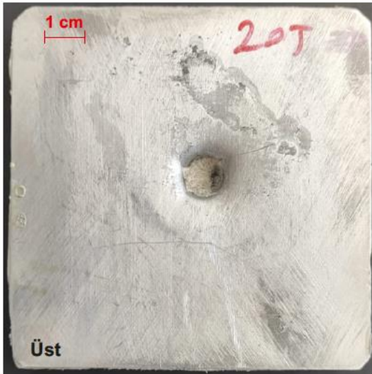
Şekil 4.2. T0 kompozit malzemenin 20 J'lük darbe enerjisine karşılık elde edilen, kuvvet-zaman, kuvvet-deplasman, enerji-zaman grafikleri ile darbelenmiş kompozit malzemenin üst, alt ve kesit görüntüleri
