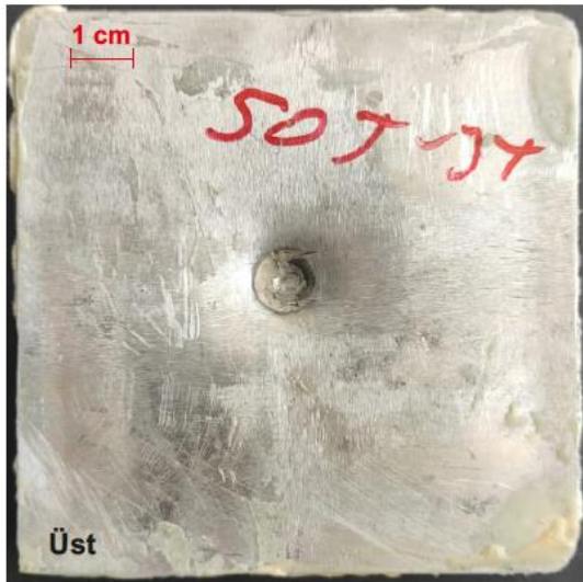
Şekil 4.26. T3 kompozit malzemenin 50 J'lük darbe enerjisine karşılık elde edilen, kuvvet-zaman, kuvvet-deplasman, enerji-zaman grafikleri ile darbelenmiş kompozit malzemenin üst, alt ve kesit görünüşleri
