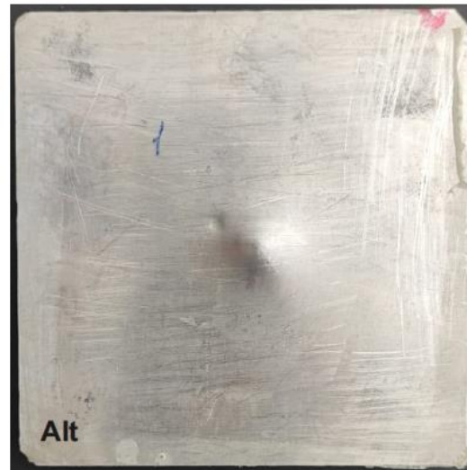
Şekil 4.5. T0 kompozit malzemenin 50 J'lük darbe enerjisine karşılık elde edilen, kuvvet-zaman, kuvvet-deplasman, enerji-zaman grafikleri ile darbelenmiş kompozit malzemenin üst, alt ve kesit görünümleri
