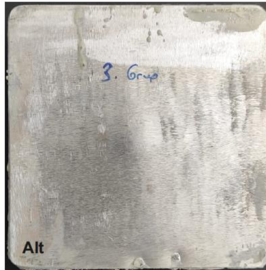
Şekil 4.17. T2 kompozit malzemenin 30 J'lük darbe enerjisine karşılık elde edilen, kuvvet-zaman, kuvvet-deplasman, enerji-zaman grafikleri ile darbelenmiş kompozit malzemenin üst, alt ve kesit görüntüleri
