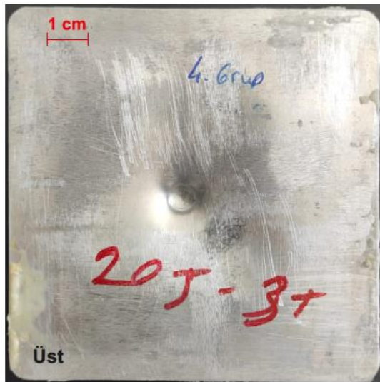
Şekil 4.23. T3 kompozit malzemenin 20 J'lük darbe enerjisine karşılık elde edilen, kuvvet-zaman, kuvvet-deplasman, enerji-zaman grafikleri ile darbelenmiş kompozit malzemenin üst, alt ve kesit görüntüleri
