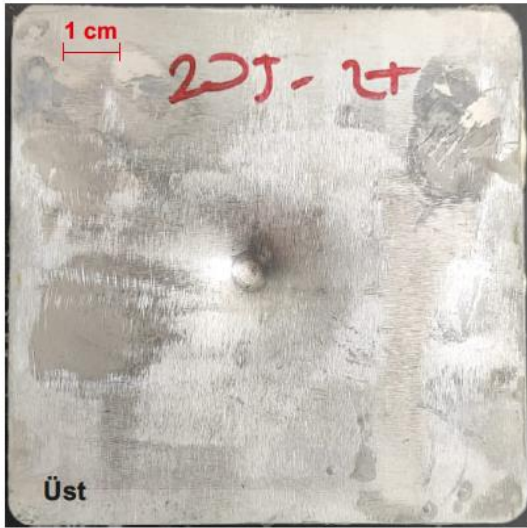
Şekil 4.16. T2 kompozit malzemenin 20 J'lük darbe enerjisine karşılık elde edilen, kuvvet-zaman, kuvvet-deplasman, enerji-zaman grafikleri ile darbelenmiş kompozit malzemenin üst, alt ve kesit görüntüleri
