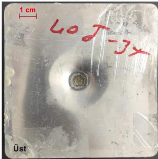
Şekil 4.25. T3 kompozit malzemenin 40 J'lük darbe enerjisine karşılık elde edilen, kuvvet-zaman, kuvvet-deplasman, enerji-zaman grafikleri ile darbelenmiş kompozit malzemenin üst, alt ve kesit görüntüleri
