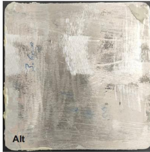
Şekil 4.16. T2 kompozit malzemenin 20 J'lük darbe enerjisine karşılık elde edilen, kuvvet-zaman, kuvvet-deplasman, enerji-zaman grafikleri ile darbelenmiş kompozit malzemenin üst, alt ve kesit görüntüleri
