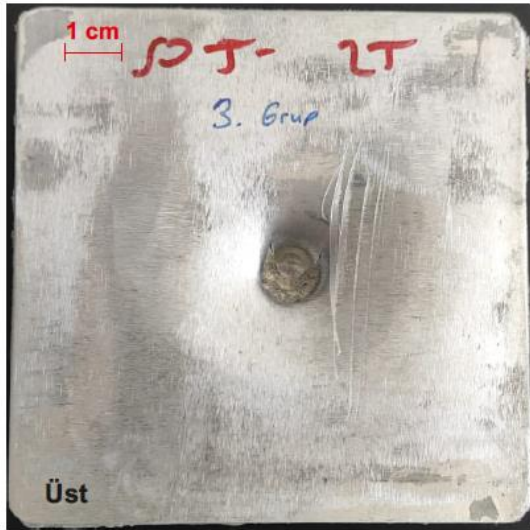
Şekil 4.19. T2 kompozit malzemenin 50 J'lük darbe enerjisine karşılık elde edilen, kuvvet-zaman, kuvvet-deplasman, enerji-zaman grafikleri ile darbelenmiş kompozit malzemenin üst, alt ve kesit görüntüleri
