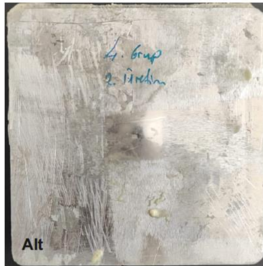
Şekil 4.25. T3 kompozit malzemenin 40 J'lük darbe enerjisine karşılık elde edilen, kuvvet-zaman, kuvvet-deplasman, enerji-zaman grafikleri ile darbelenmiş kompozit malzemenin üst, alt ve kesit görüntüleri
