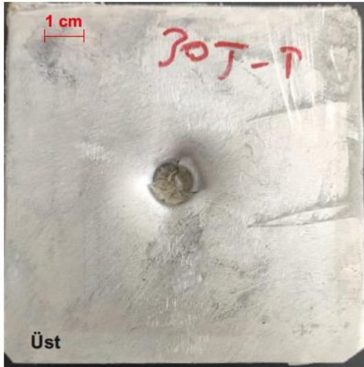
Şekil 4.10. T1 kompozit malzemenin 30 J'lük darbe enerjisine karşılık elde edilen, kuvvet-zaman, kuvvet-deplasman, enerji-zaman grafikleri ile darbelenmiş kompozit malzemenin üst, alt ve kesit görünümleri
