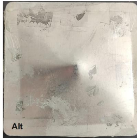
Şekil 4.19. T2 kompozit malzemenin 50 J'lük darbe enerjisine karşılık elde edilen, kuvvet-zaman, kuvvet-deplasman, enerji-zaman grafikleri ile darbelenmiş kompozit malzemenin üst, alt ve kesit görüntüleri
