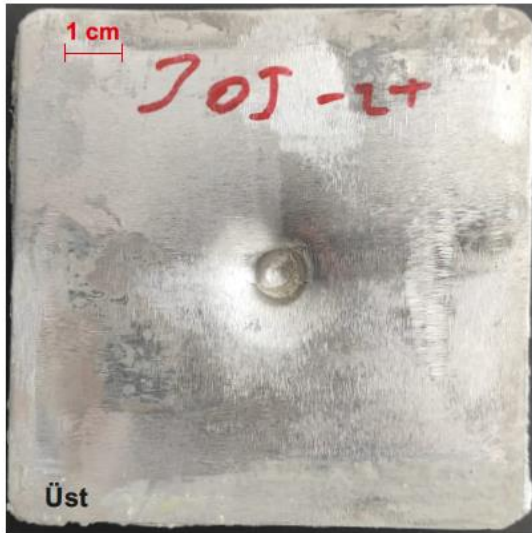
Şekil 4.17. T2 kompozit malzemenin 30 J'lük darbe enerjisine karşılık elde edilen, kuvvet-zaman, kuvvet-deplasman, enerji-zaman grafikleri ile darbelenmiş kompozit malzemenin üst, alt ve kesit görüntüleri
