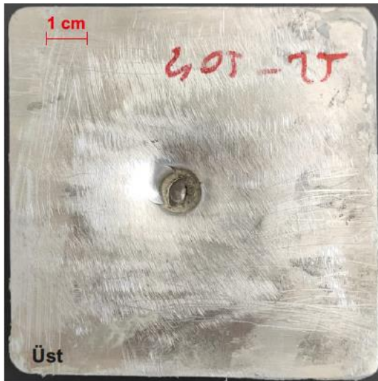
Şekil 4.18. T2 kompozit malzemenin 40 J'lük darbe enerjisine karşılık elde edilen, kuvvet-zaman, kuvvet-deplasman, enerji-zaman grafikleri ile darbelenmiş kompozit malzemenin üst, alt ve kesit görüntüleri
