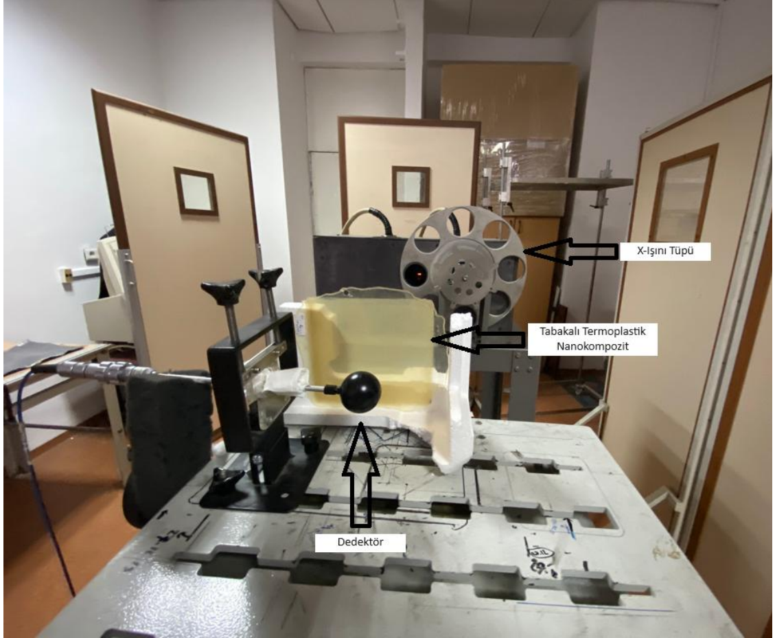
Şekil 4.13. X-Işını Azalım Testleri İçin Kurulan Düzenek
