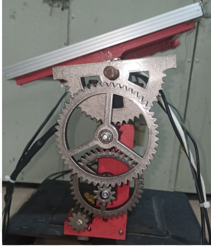
Şekil 3.5. Doğu batı dönüşünde kullanılan dişli sistemi
