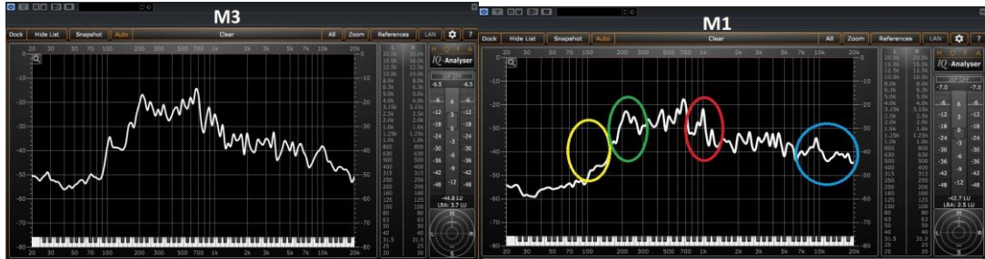
Şekil- 66: "M3" İle "M1" Mikrofonlama Teknikleri Spectrum Analyser Karşılaştırmaları.
