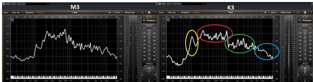
Şekil- 73: “M3” ile “K3” Mikrofonlama Teknikleri Spectrum Analyser Sonuçlarının Karşılaştırmaları
