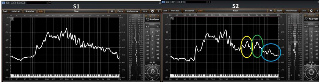
Şekil- 82: “S1” ile “S2” Mikrofonlama Teknikleri Spectrum Analyser Sonuçlarının Karşılaştırmaları
