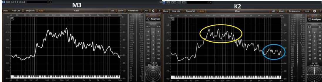
Şekil- 72: “M3” ile “K2” Mikrofonlama Teknikleri Spectrum Analyser Sonuçlarının Karşılaştırmaları
