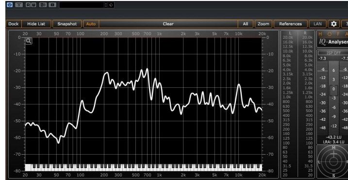
Şekil- 58: "M6" Mikrofonlama Tekniđi Spectrum Analyser Sonucu.
