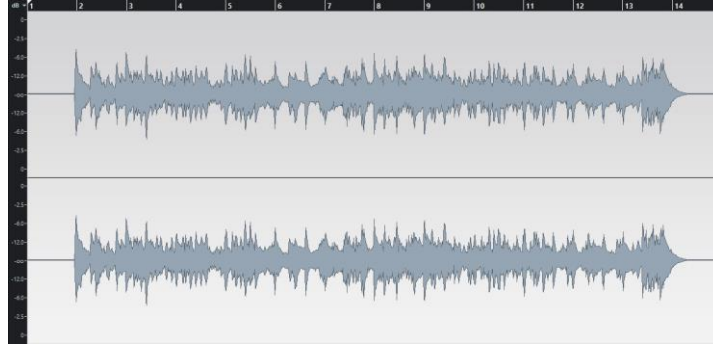
Şekil- 87: "Comp3" Kompresör Türünün Wave Editor Analyser Sonucu.
