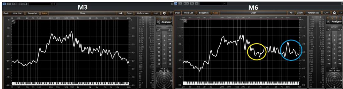
Şekil- 70: “M3” ile “M6” Mikrofonlama Teknikleri Spectrum Analyser Sonuçlarının Karşılaştırmaları
