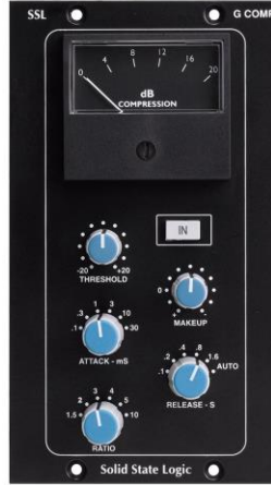
Şekil- 17: “VCA” Kompresör Örneği: SSL G Comp
