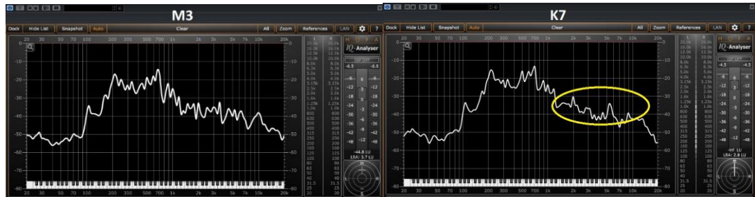
Şekil- 77: “M3” ile “K7” Mikrofonlama Teknikleri Spectrum Analyser Sonuçlarının Karşılaştırmaları
