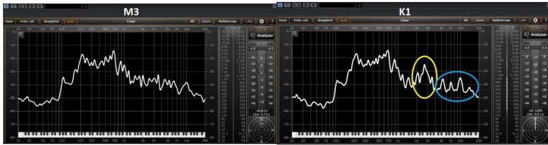
Şekil- 71: “M3” ile “K1” Mikrofonlama Teknikleri Spectrum Analyser Sonuçlarının Karşılaştırmaları
