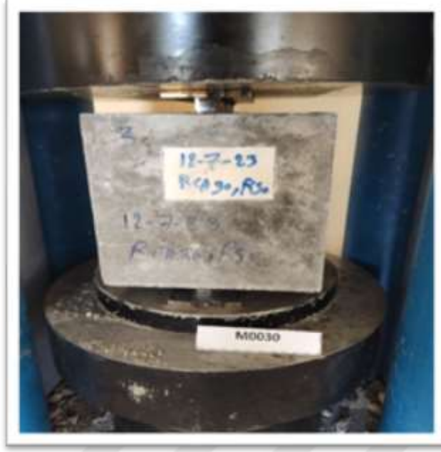
Şekil 3.13. Betonun yarmada-çekme dayanımı deneyinin yapılışı.
