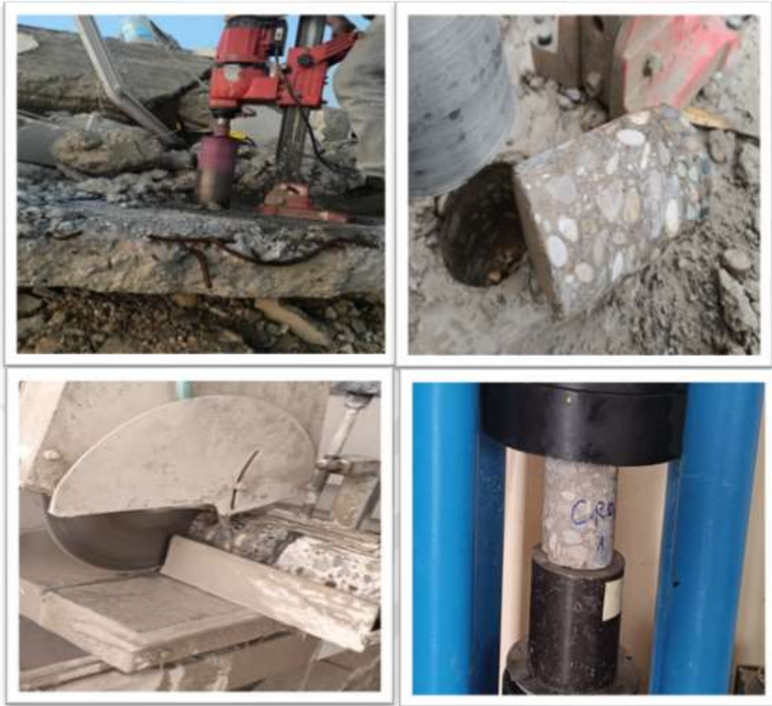
Şekil 3.3. Karot numunelerinin alınması.
