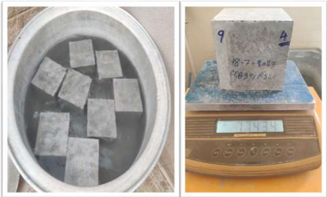
Şekil 3.14. Sertleşmiş betonda yoğunluk, emme ve boşluk oranı testleri.
