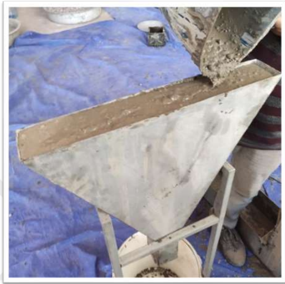
Şekil 3.10. V-hunisi deneyinin yapılışı.
