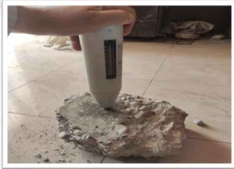
Şekil 3.2. Schmidt yüzey sertliği deneyi.
