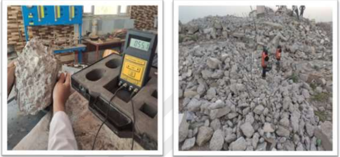
Şekil 3.1. Ultrases geçiş hızı deneyi yapıışı.
