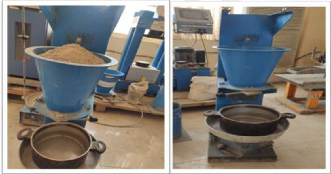
Şekil 3.5. Agrega paketleme yoğunluğunu belirlemek için test kurulumu.
