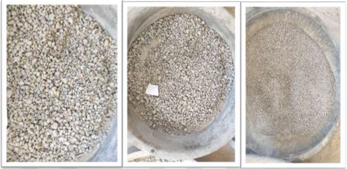
Şekil 3.4. Agrega paketleme yoğunluğu deneyinde kullanılan, geri dönüştürülmüş iri agregata (19 mm ve 12,5 mm) ve geri dönüştürülmüş ince agregata.
