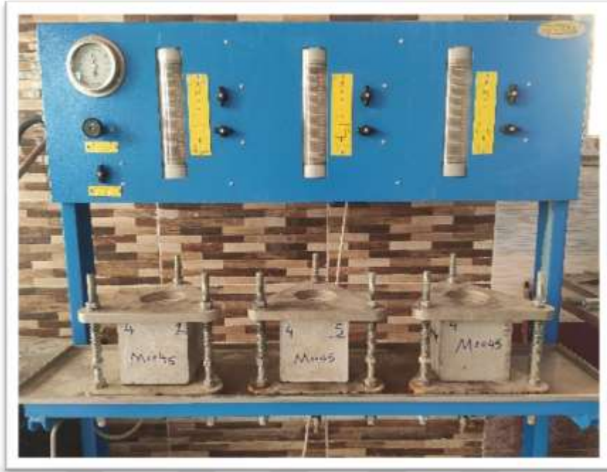
Şekil 3.16. Basınç altında betona su işleme derinliğinin test edilmesi.
