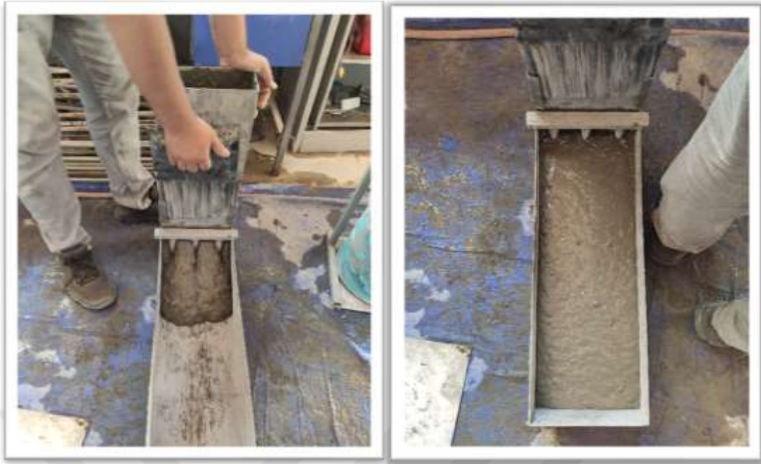
Şekil 3.11. L-kutusu deneyinin yapılışı.
