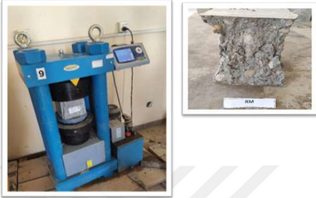
Şekil 3.12. Betonun basınç dayanımı deneyinin yapılışı.
