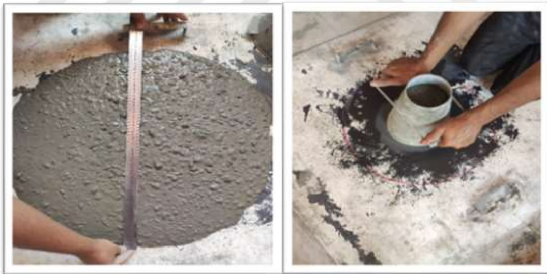
Şekil 3.9. T_{500} ve çökme-yayılmanın deneyinin yapılışı.
