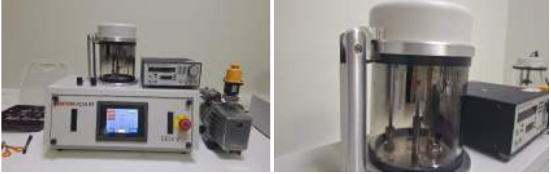
Şekil 3.22. Altın/paladyum kaplamasında kullanılan test cihazı
