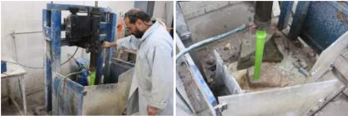
Şekil 3.6. Karot numunelerinin hazırlanması
