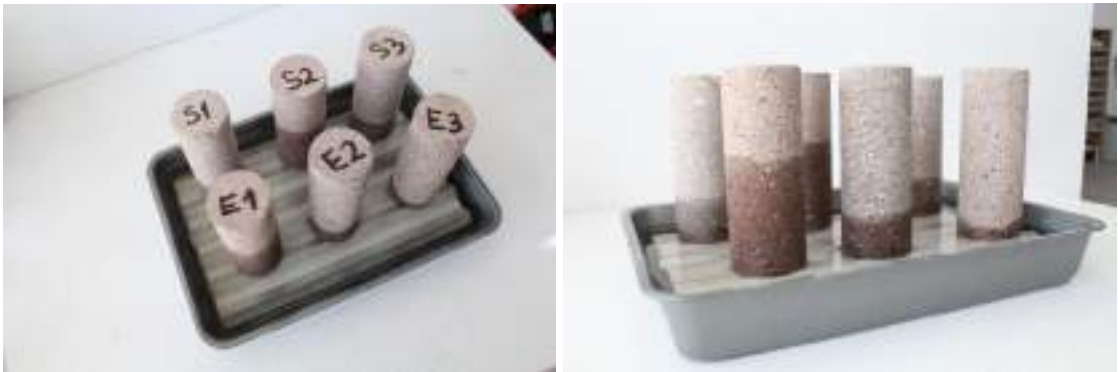
Şekil 4.6. Deney sonunda numunelerde yükselen su seviyeleri
