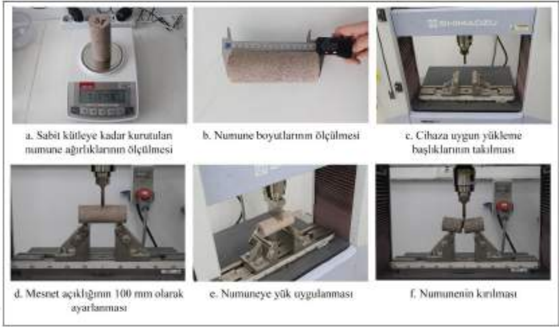
Şekil 3.18. Eğilme dayanımı deney süreci
