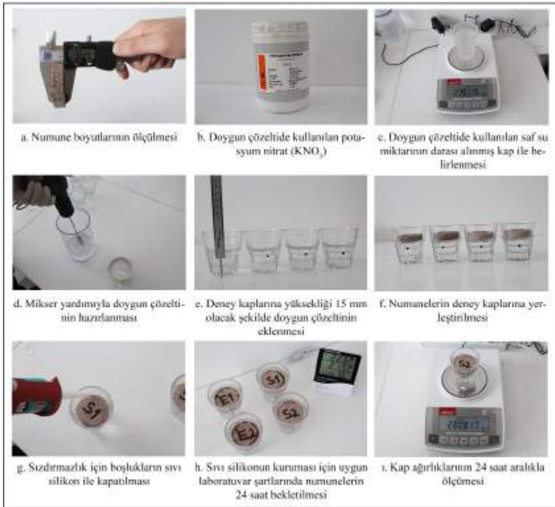
Şekil 3.14. Su buharı geçirgenlik deneş süreci
