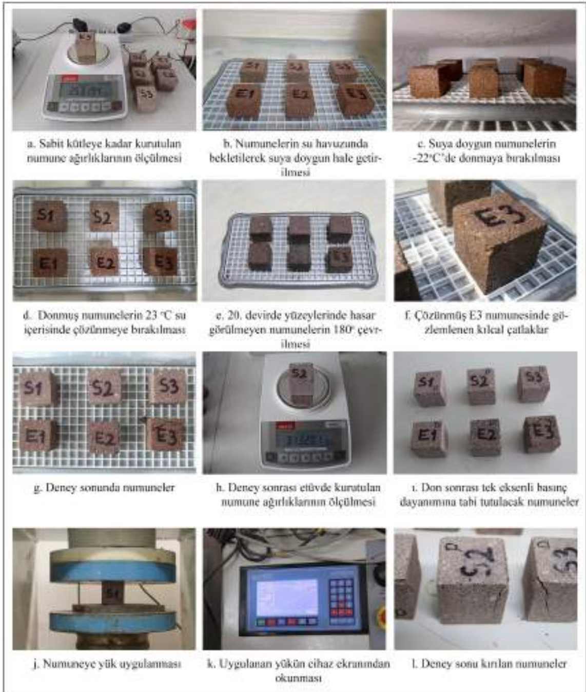
Şekil 3.21. Don tesirlerine dayanım deney süreci
