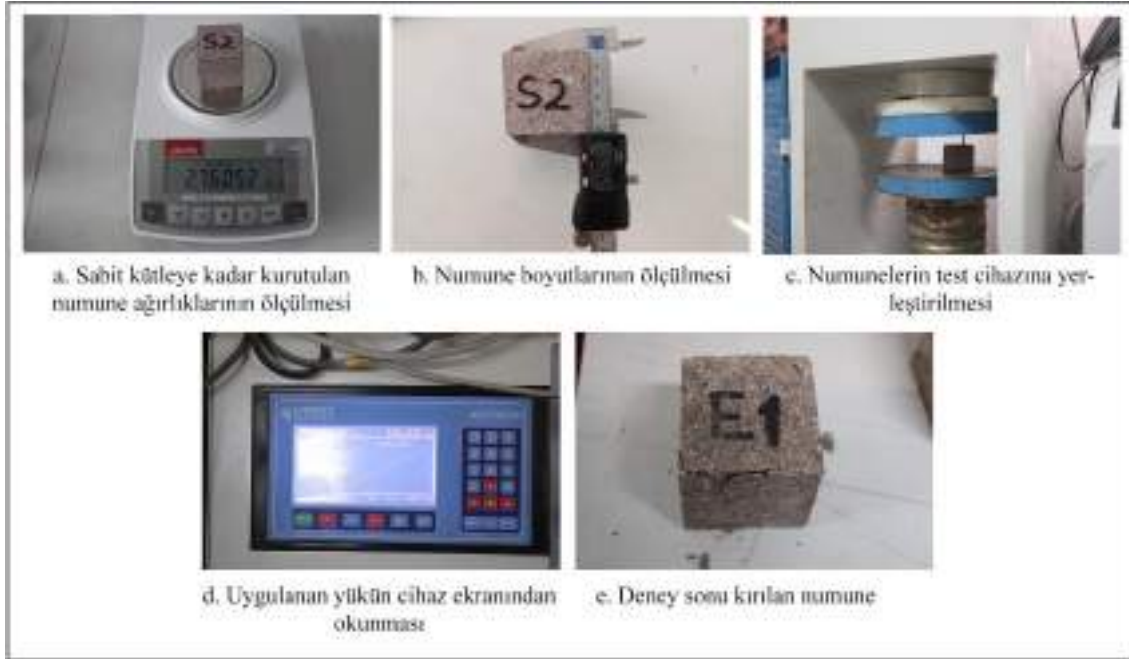
Şekil 3.16. Tek eksenli basınç dayanımı deney süreci
