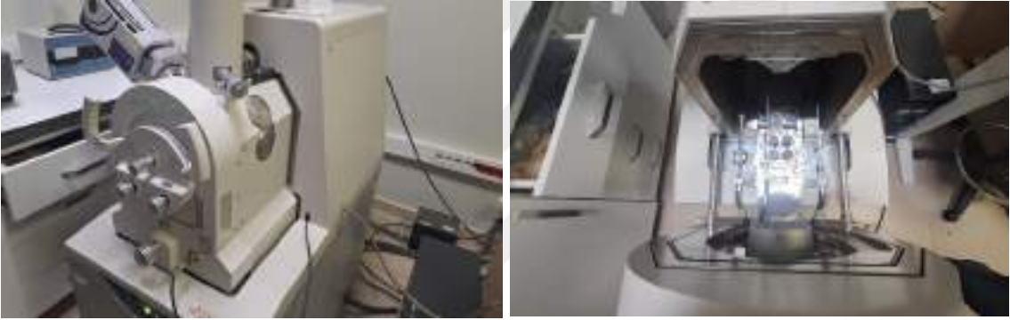
Şekil 3.23. SEM analizinde kullanılan test cihazı
