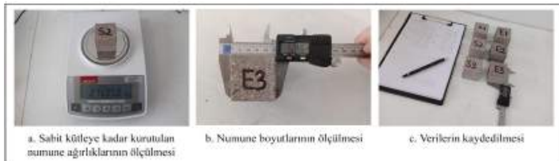
Şekil 3.12. Görünür yoğunluk deney süreci
