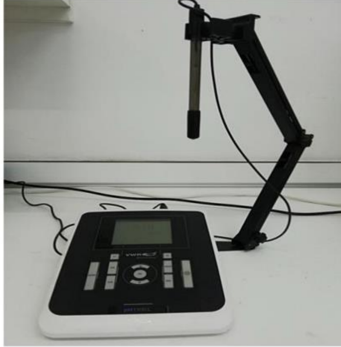
řekil 3.3. Thermo Scientific Orion 9106BNWP kombine cam pH elektrotu ve onun bađlı bulunduđu VWR Int Geldenaaksebaan 464 B-3001 Leuven pH 1100 L model pH iyon metre
