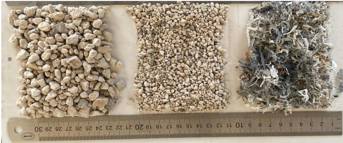
Şekil 3.3. Beton karışımlarında kullanılan kaba agrega, ince agrega ve plastik atık
