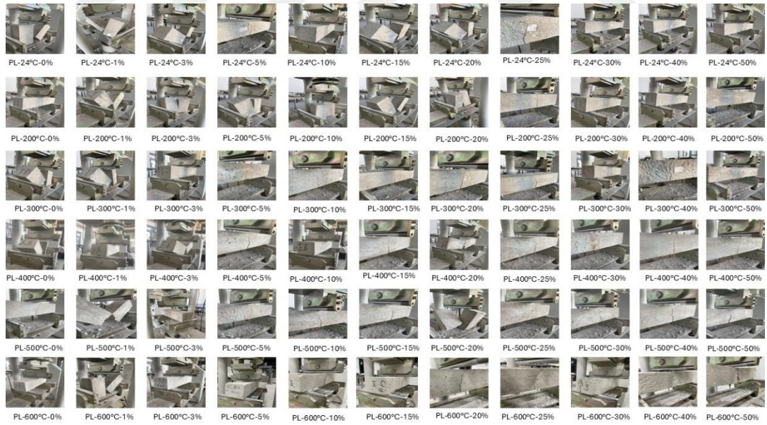
Şekil 4.6. Çeşitli plastik içerik ve termal koşullarda beton eğilme özelliklerinin kırılma davranışı
