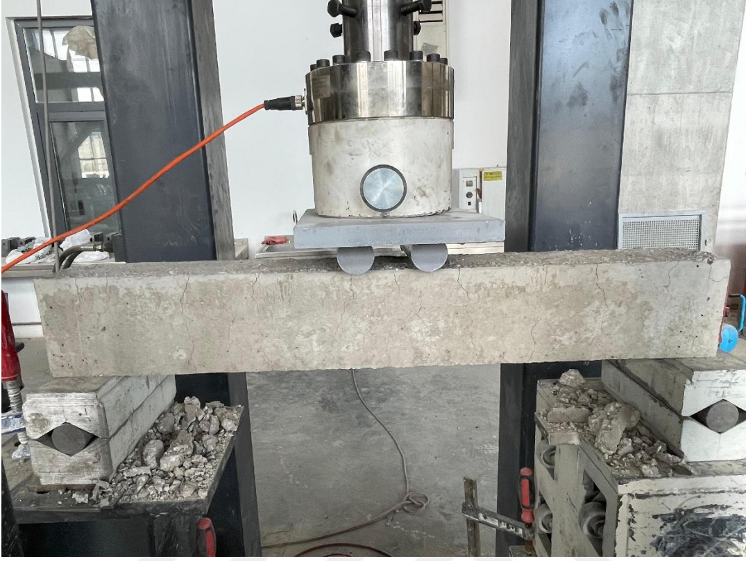
Şekil 3. 8. Betonarme kiriş numunesinin eğilme deneyi düzeneği
