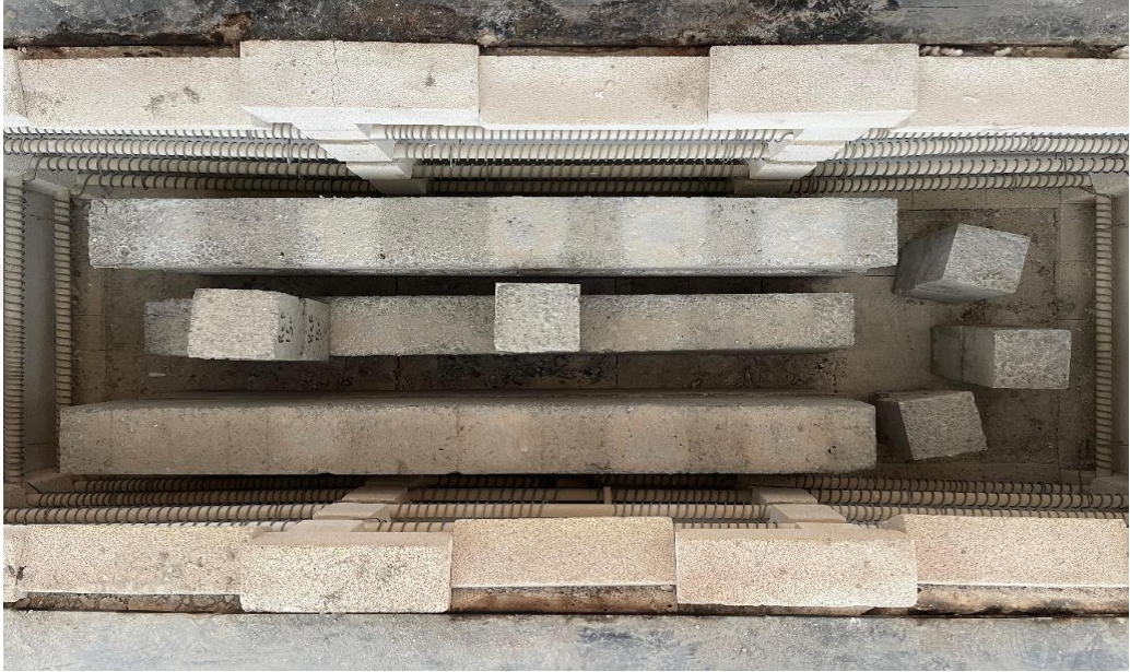
Şekil 3.7. Yüksek sıcaklık deneyi için fırın içerisine yerleştirilen küp ve kiriş numuneleri
