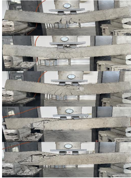
Şekil 4.9. Dört noktali eğilme deneyi sırasında donatılı beton kirişte çatlak gelişimi ve nihai göçme durumu
