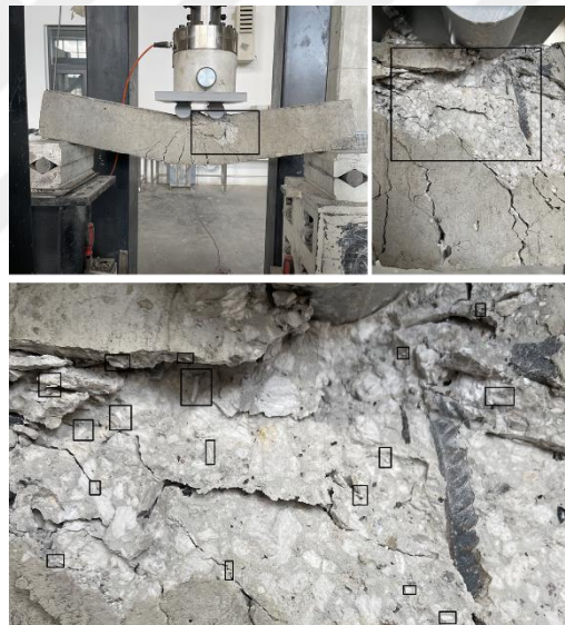
Şekil 4.10. Donatılı beton kirişin orta açıklık bölgesinde çatlak ilerlemesi
