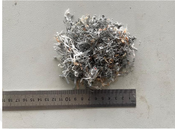
Şekil 3.1. Deneylerde kullanılan kesilmiş plastik atıkların genel görünümü ve boyutlarının gösterimi
