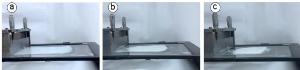
Şekil 3.8. Dr. Blade sistemi ile farklı kalınlıklarda nBNS dökme işlemine ait görseller. a) 2 mm, b) 3 mm kalınlık, c) 5 mm kalınlık
