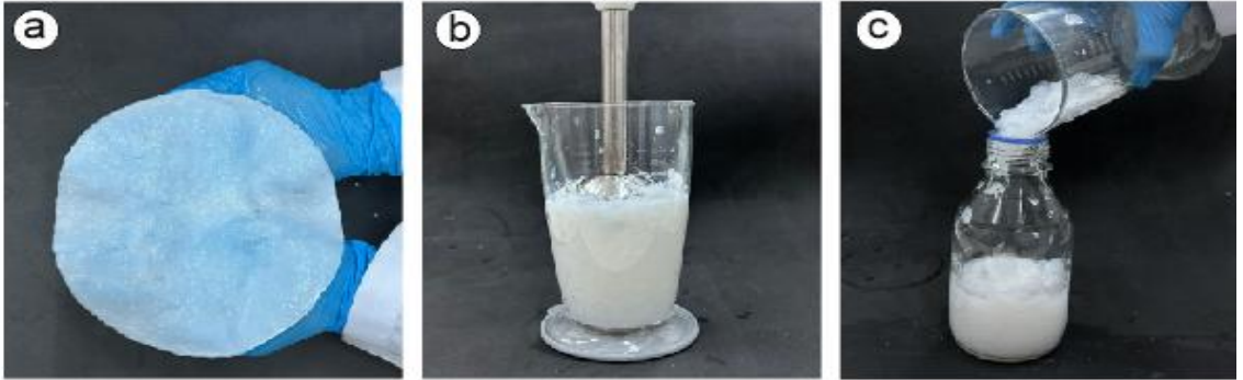
Şekil 3.5. BNS'nin parçalanması ait görseller. a) Saflaştırılmış BNS, b) BNS'nin parçalayıcı (blender) yardımıyla homojen olarak parçalanması, c) Saklamak için uygun kapaklı bir malzeme içerisine alınmasına ait görseller
