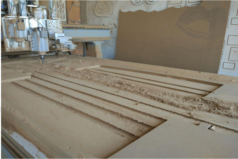
Şekil 3.14. Mdf Kalıp CNC İşleme
