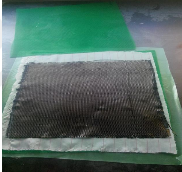
řekil 3.3. Karbon Kumař Yerleřtirilmesi
