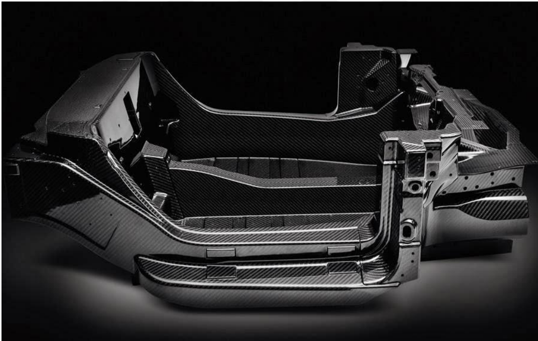
Şekil 2.20. Alfa Romeo 4C' nin karbon fiber şasesi[23]
