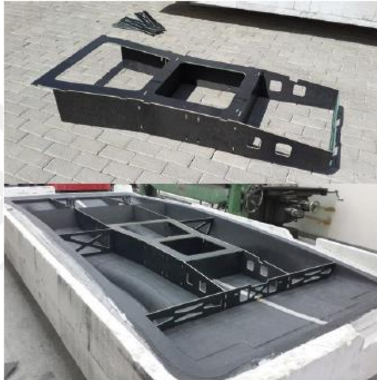
Şekil 2.19. Şasi ve Gövde Birleştirme İşlemi[21]
