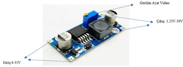
Şekil 3. 13. LM 2596 Gerilim Regülatörü
