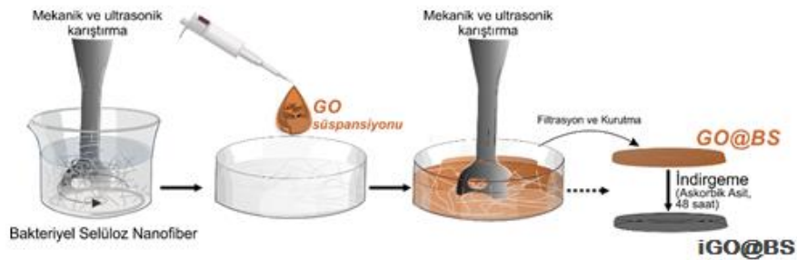
Şekil 3.5. Grafen oksit bakteriyel selüloz (GO@BS) ve indirgenmiş grafen oksit bakteriyel selüloz (iGO@BS) kompozit malzemelerin hazırlanmasının şematik gösterimi
