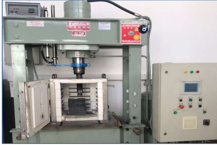
Şekil 5. 4. Deney numunelerinin preslenmesinde kullanılan 160 tonluk pres tezgâhı
