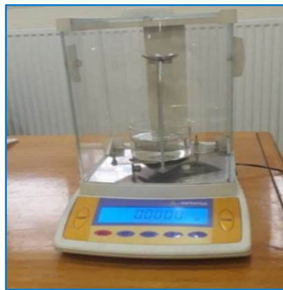
Şekil 5. 5. Yoğunluk ölçümlerinde kullanılan hassas terazi
