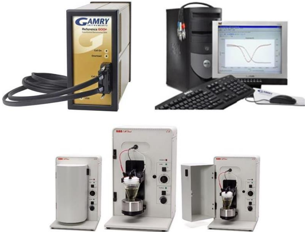
Şekil 3.1. Voltametri ve impedans deneylerinin gerçekleştirildiği GAMRY Reference 600+ ve Series 750 elektrokimyasal analizörleri ve C3 hücre sistemi.
