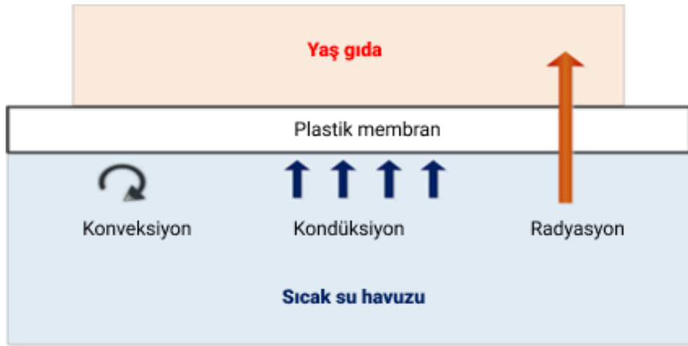
Şekil 2. 3. Kırınım pencereleli kurutmada ısı transfer mekanizması (Ortiz Jerez ve ark., 2015)
