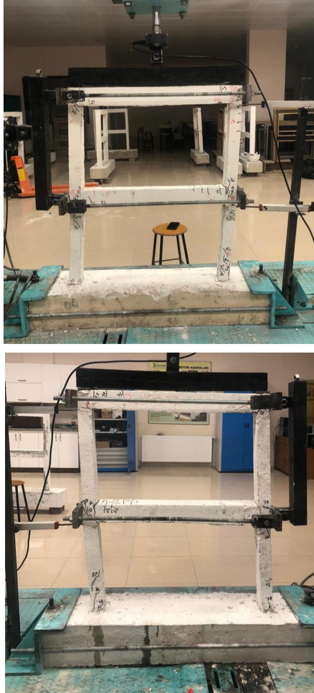
Şekil 4.19. Deney numunesi 2'nin akma sonrası görünümü (+14 itme çevrimi)
