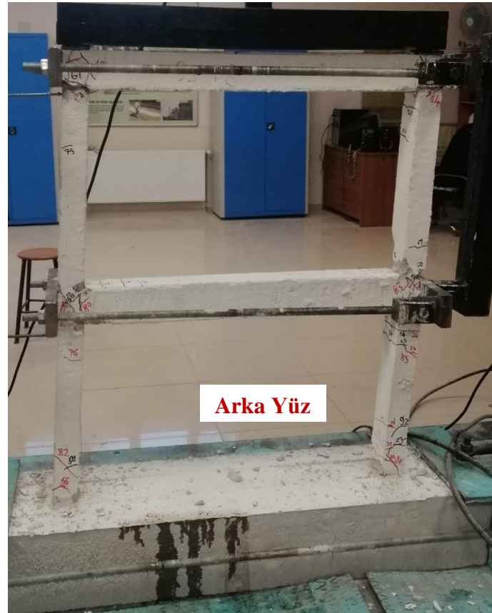
Şekil 4.34. Deneş numunesi 3'ün, göçme konumunda ön ve arka yüzden görünümü (+17 itme çevrimi)
