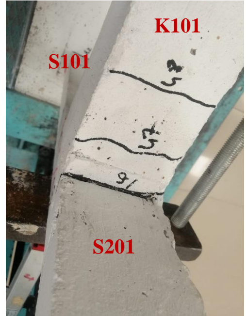
Şekil 4.32. Deney numunesi 3'ün akma sonrası görünümü (+10 itme çevrimi)
