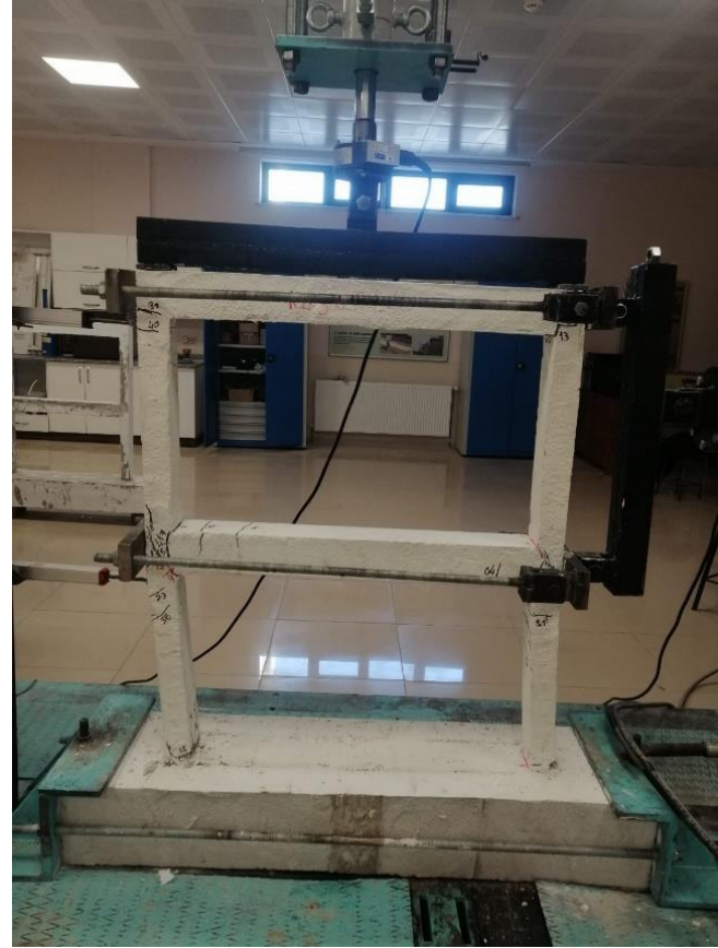
Şekil 4.6. Deneş numunesi 1'nin akma sonrası görünümü (+8 itme çevrimi)
