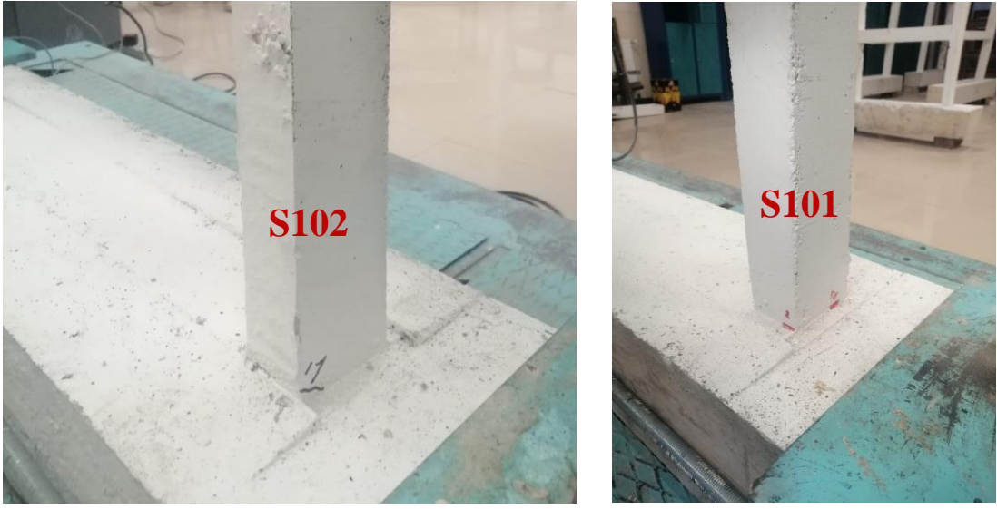
Şekil 4.31. Deney numunesi 3'te, itme ve çekme çevrimlerinde oluşan ilk çatlaklar
