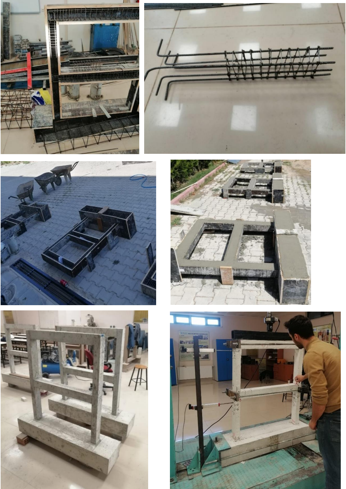
Şekil 3.1. Betonarme çerçevelerin üretim sürecine ait fotoğraflar
