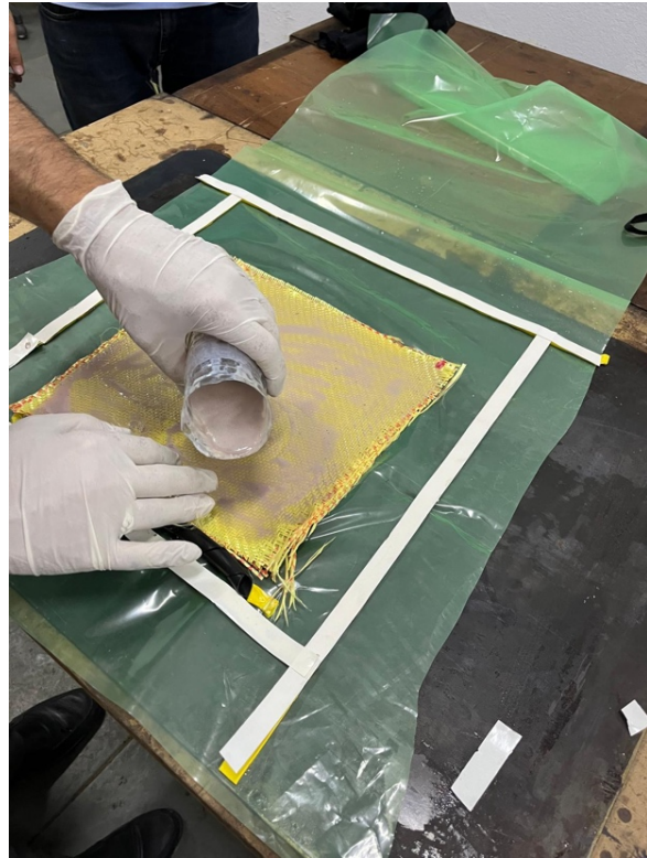
Şekil 14. El yatırma yöntemi
