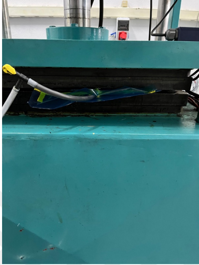
Şekil 12. Sıcak pres vakum torbalama (kapalı hali)
