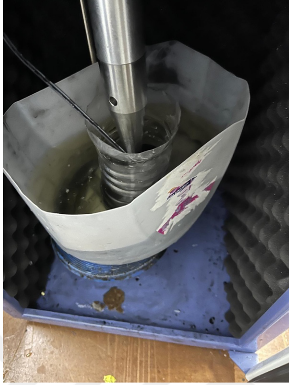
Şekil 13. Ultrasonik karıştırıcı (soğuk su ile)
