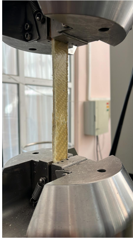
Şekil 21. Çekme deney testi numune görüntüsü
