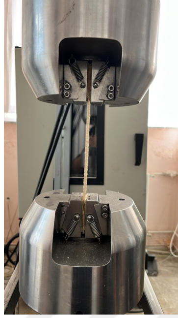
Şekil 20. Çekme deney testi
