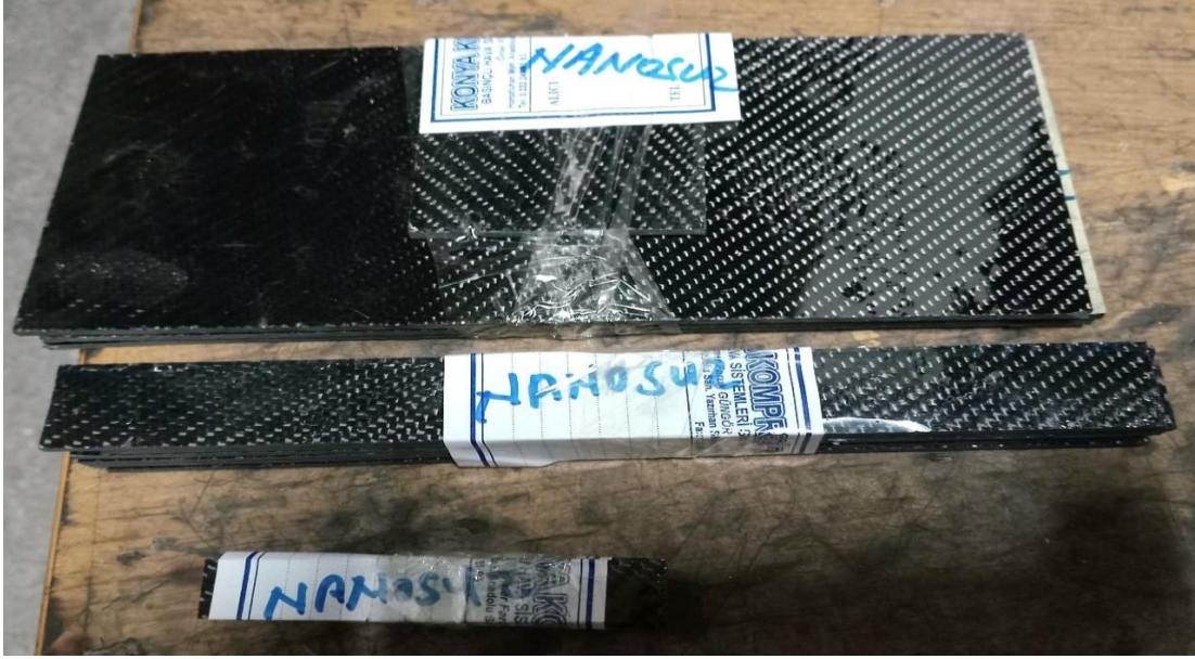
Şekil 6.8. Kesilmiş delme, üç nokta eğme ve çekme deney numuneleri
