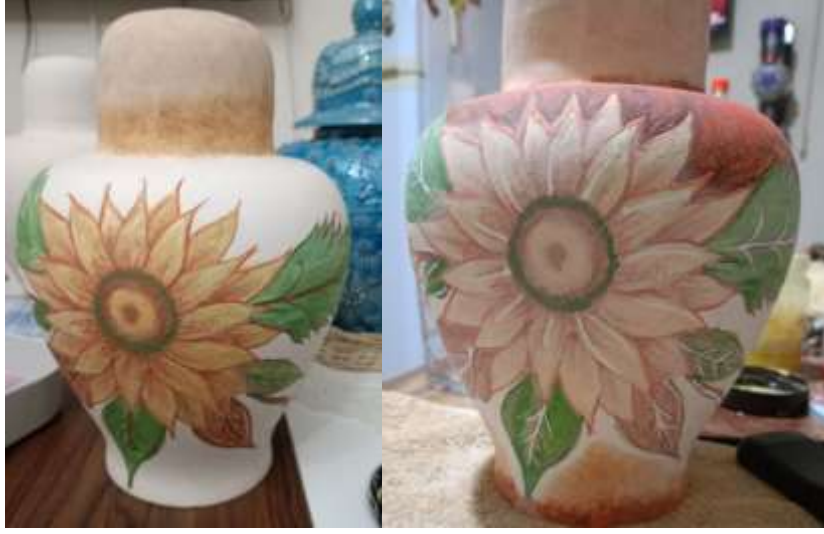
Görsel 47: Birinci Pişirim Yapılan Ürüne Desen Çizilmesi ve Boyanması
